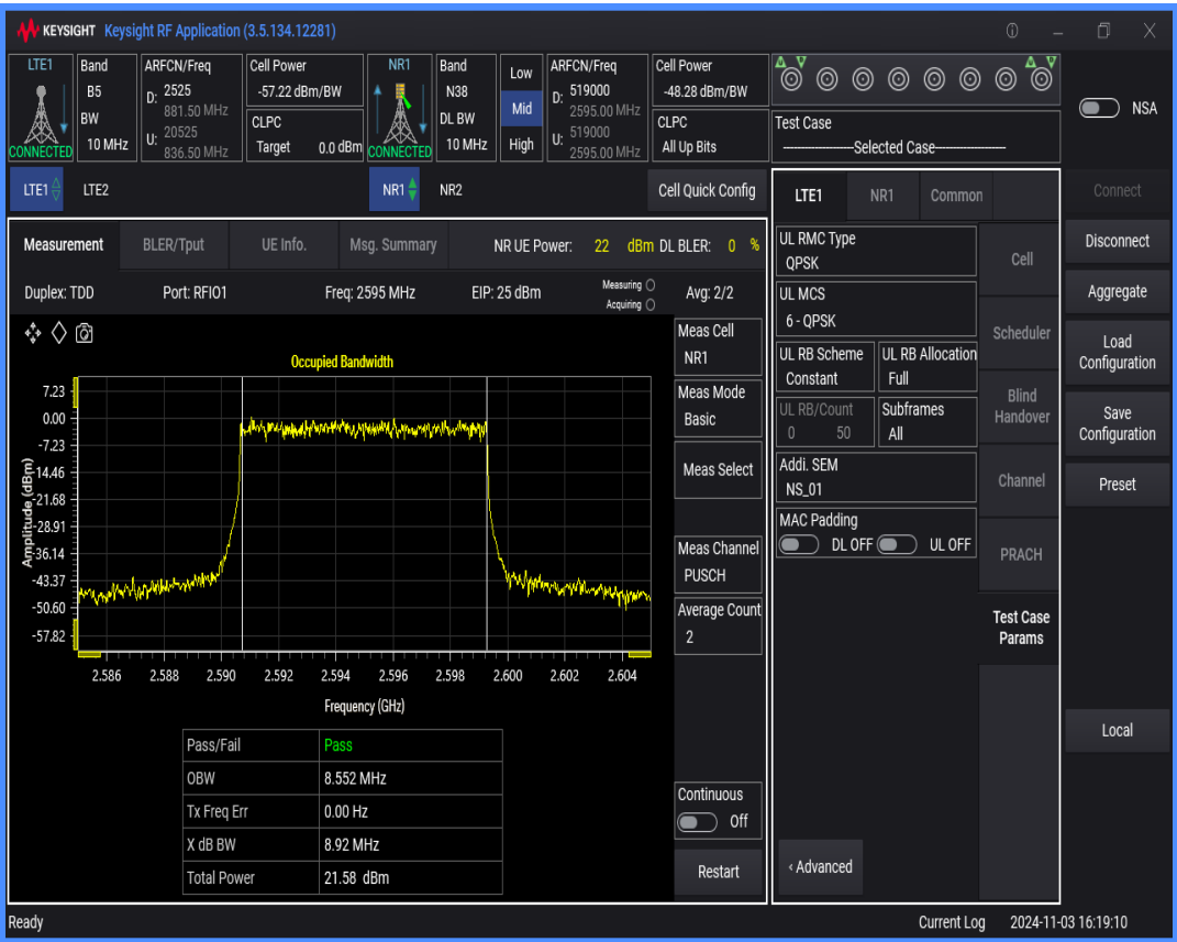
n38 SCS=30kHz DFT_QPSK BW=10MHz Channel=519000 RB=24@0
