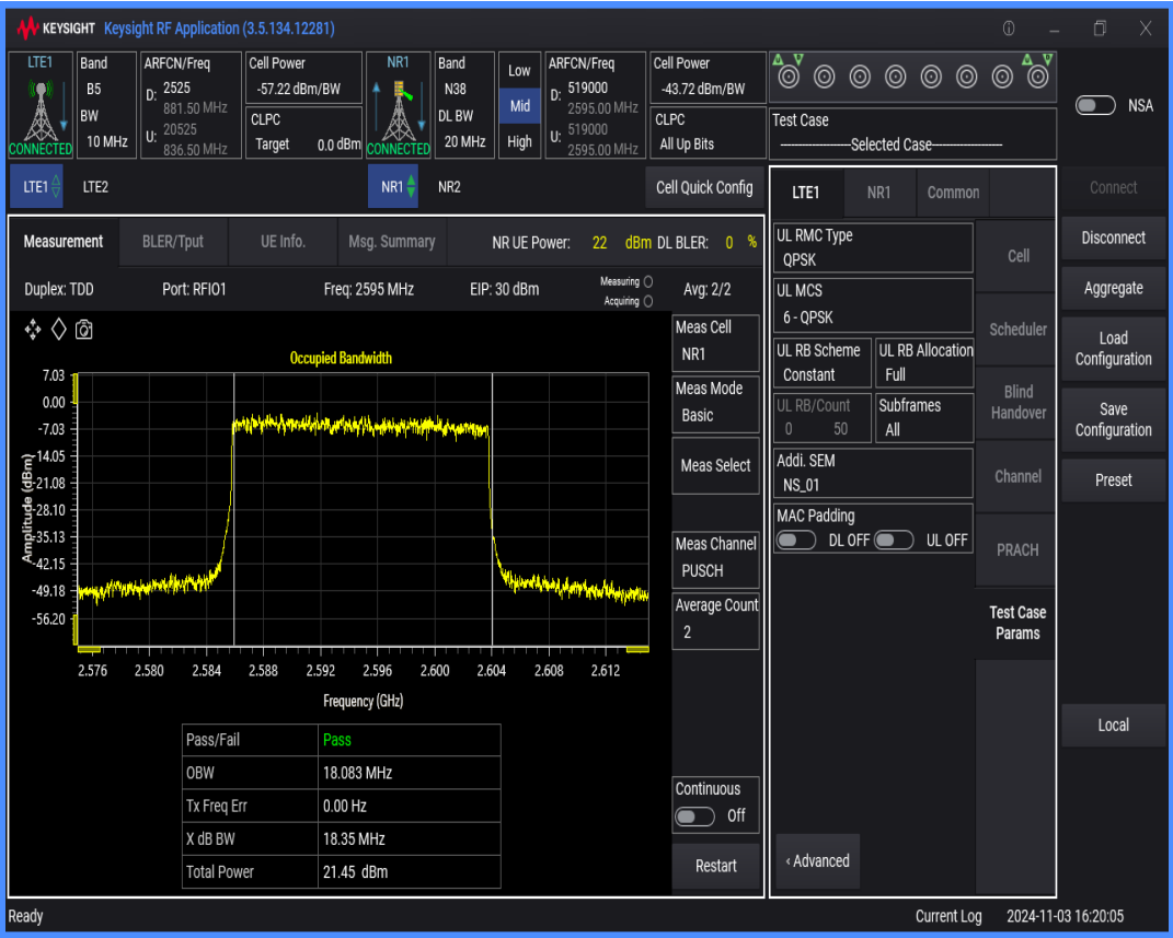
n38 SCS=30kHz DFT_QAM256 BW=20MHz Channel=519000 RB=50@0
