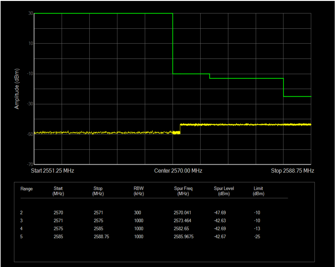
n7 SCS=15kHz CP_QPSK BW=20MHz Channel=502000 RB=106@0
