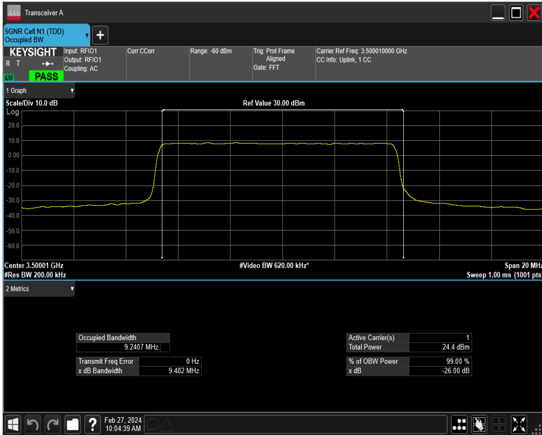
n77(3450-3550) SCS=15kHz DFT_QAM64 BW=10MHz Channel=633334 RB=50@0
