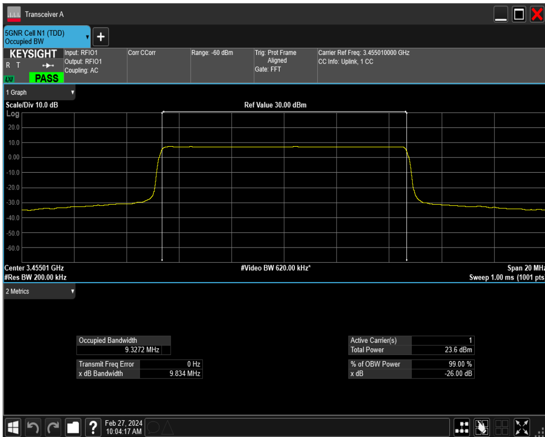
n77(3450-3550) SCS=15kHz DFT_BPSK BW=10MHz Channel=633334 RB=50@0
