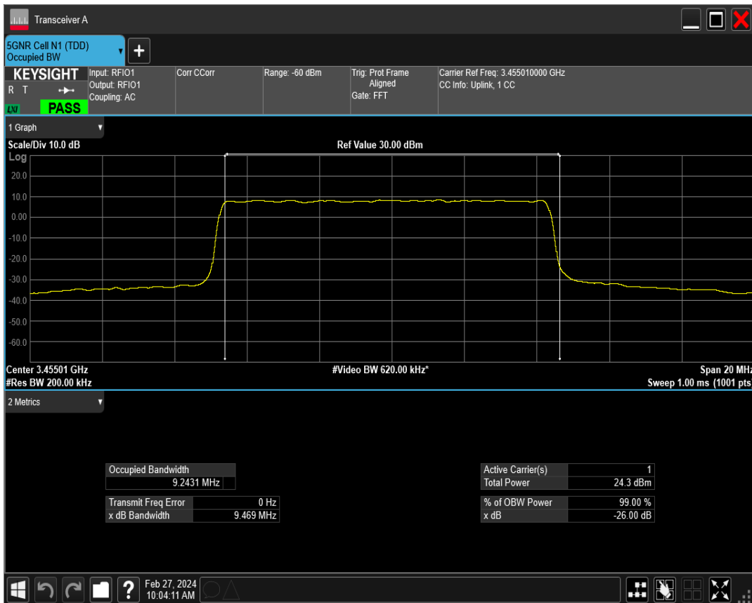
n77(3450-3550) SCS=15kHz DFT_QAM256 BW=10MHz Channel=630334 RB=50@0
