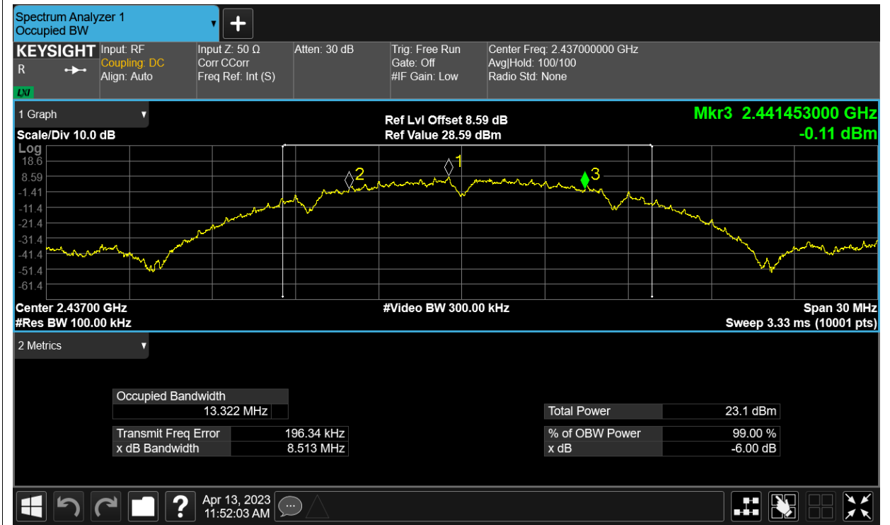
-6dB Bandwidth NVNT b 2462MHz Ant1
