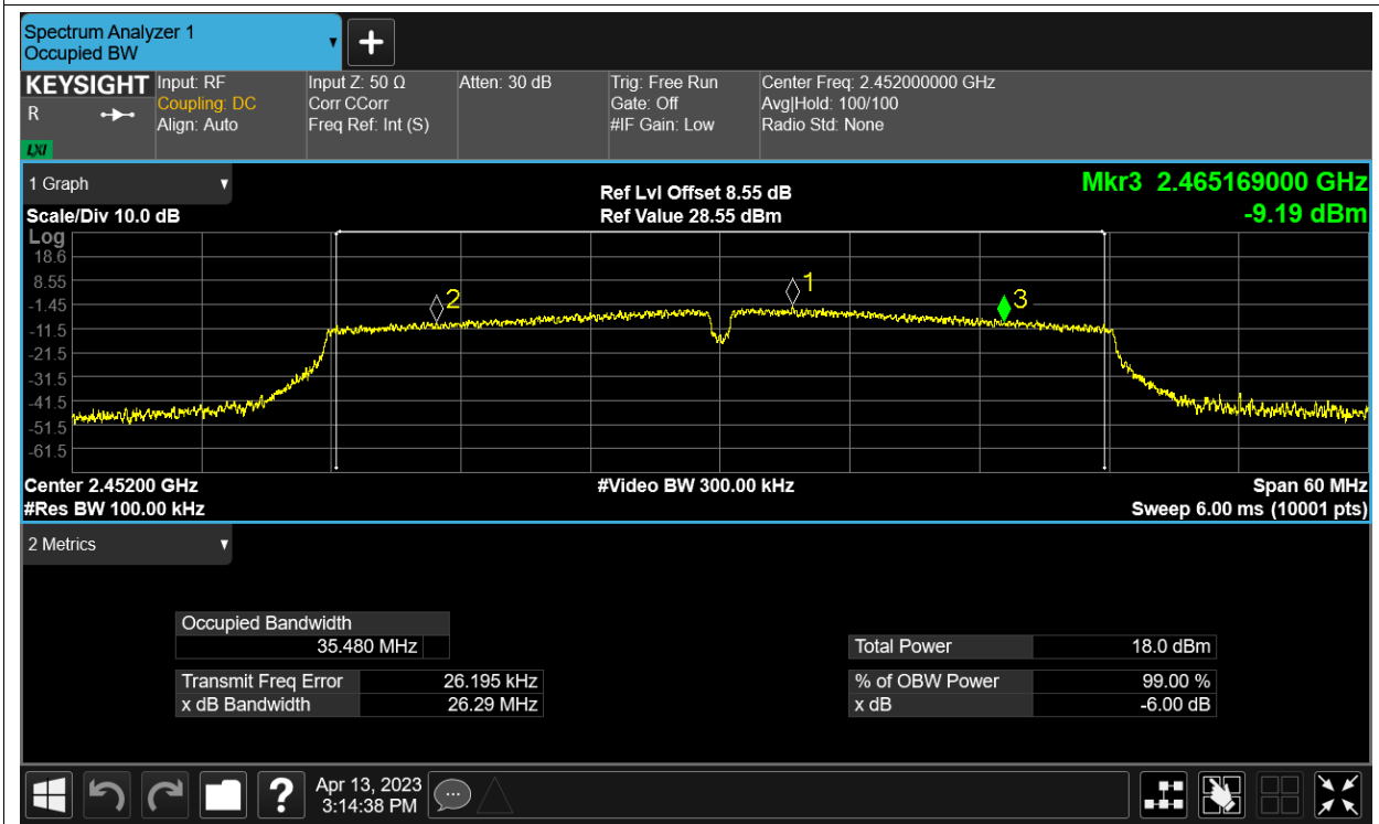
-6dB Bandwidth NVNT n40 2452MHz Ant1
