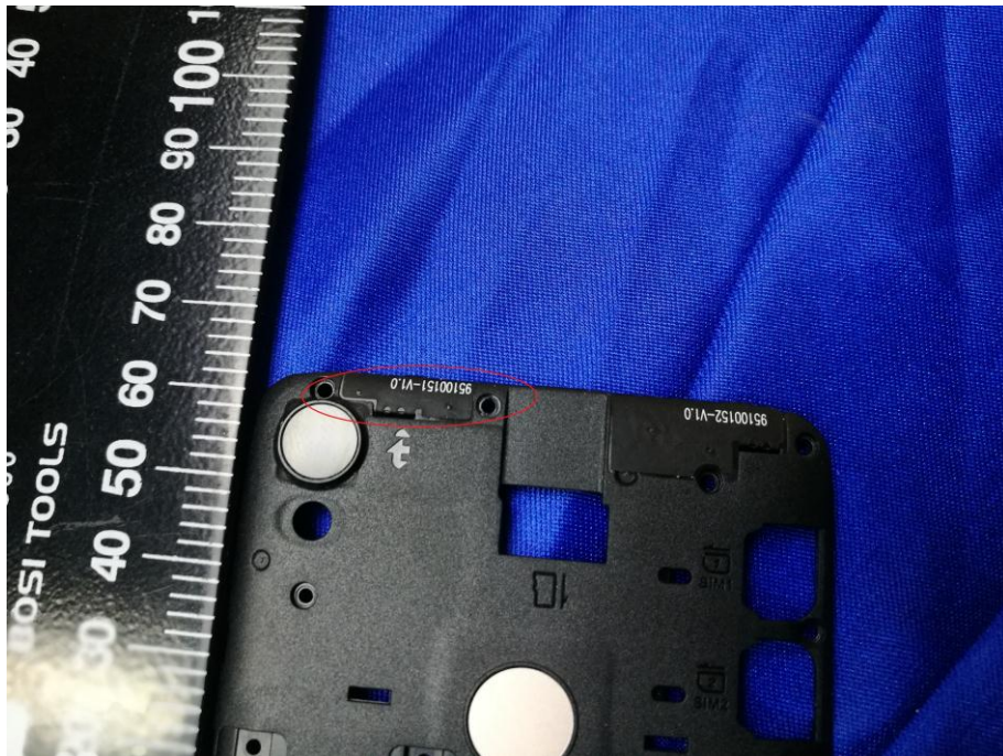
BT/WIFI/BLE/GPS - Antenna View
