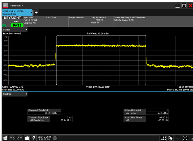
80MHz_30kHz_3490MHz_DFT-s-OFDM PI/2 BPSK_RB216@ 76.961 MHz
