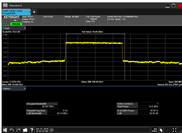
70MHz_30kHz_3515MHz_DFT-s-OFDM QPSK_RB180@0 66.867 MHz
