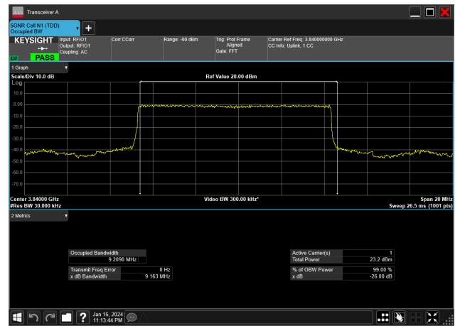
10MHz_15kHz_3840MHz_DFT-s-OFDM PI/2 BPSK_RB50@0 9.209 MHz
