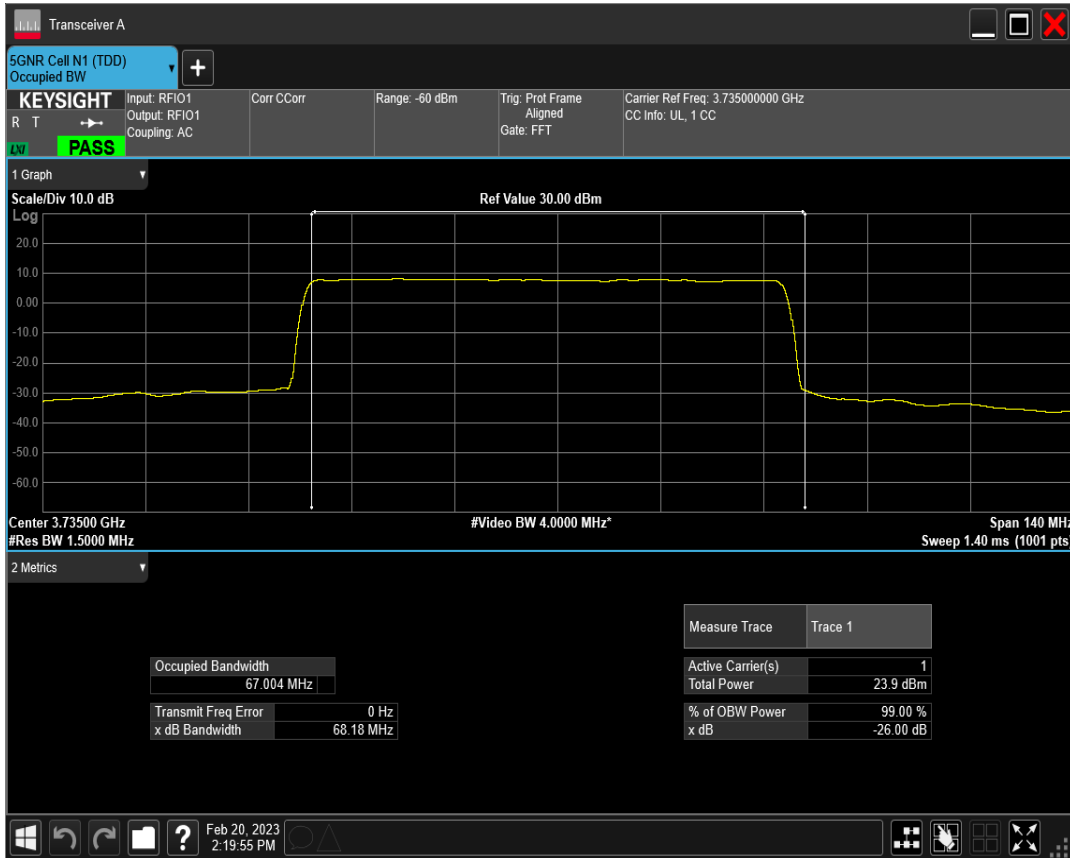
n78(3700-3800) SCS=30kHz CP_QPSK BW=70MHz Channel=649000 RB=189@0
