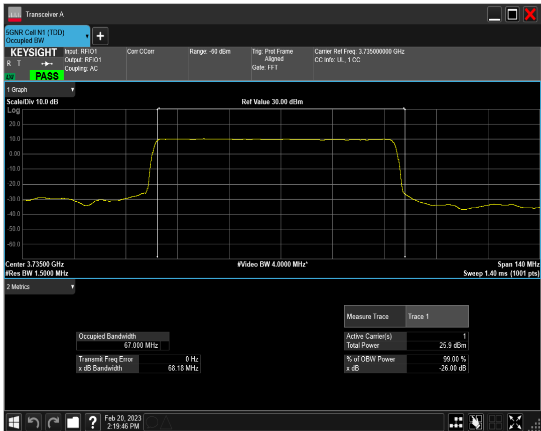
n78(3700-3800) SCS=30kHz DFT_QPSK BW=70MHz Channel=649000 RB=180@0
