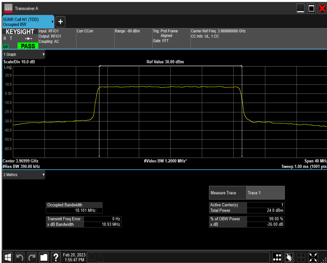
n77(3700-3980) SCS=30kHz DFT_QAM256 BW=20MHz Channel=664666 RB=50@0
