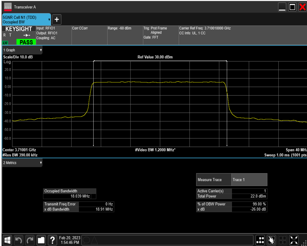
n77(3700-3980) SCS=30kHz CP_QPSK BW=20MHz Channel=647334 RB=51 @0
