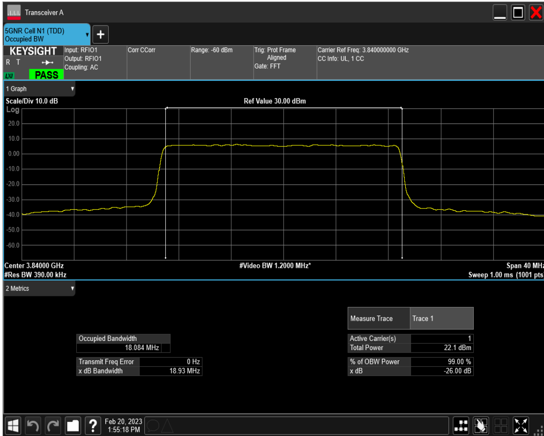
n77(3700-3980) SCS=30kHz CP_QPSK BW=20MHz Channel=656000 RB=51 @0
