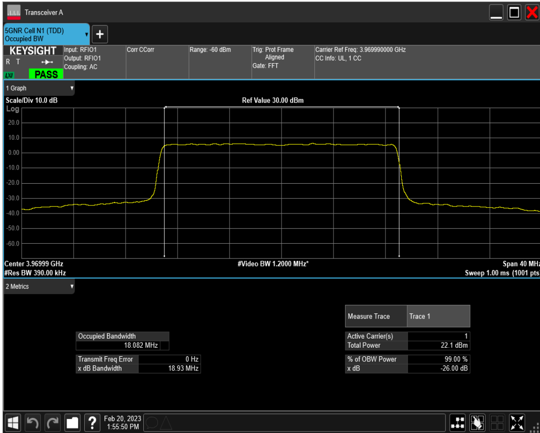
n77(3700-3980) SCS=30kHz CP_QPSK BW=20MHz Channel=664666 RB=51 @0
