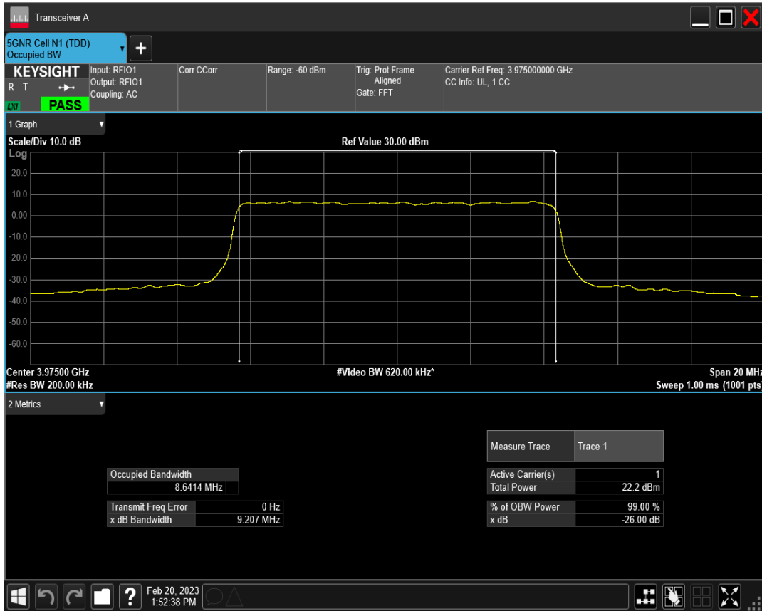
n77(3700-3980) SCS=30kHz CP_QPSK BW=10MHz Channel=665000 RB=24@0
