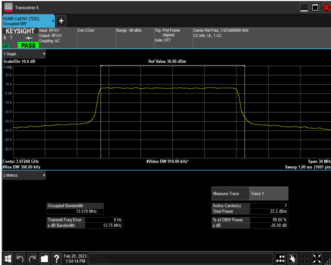
n77(3700-3980) SCS=30kHz CP_QPSK BW=15MHz Channel=664832 RB=38@0
