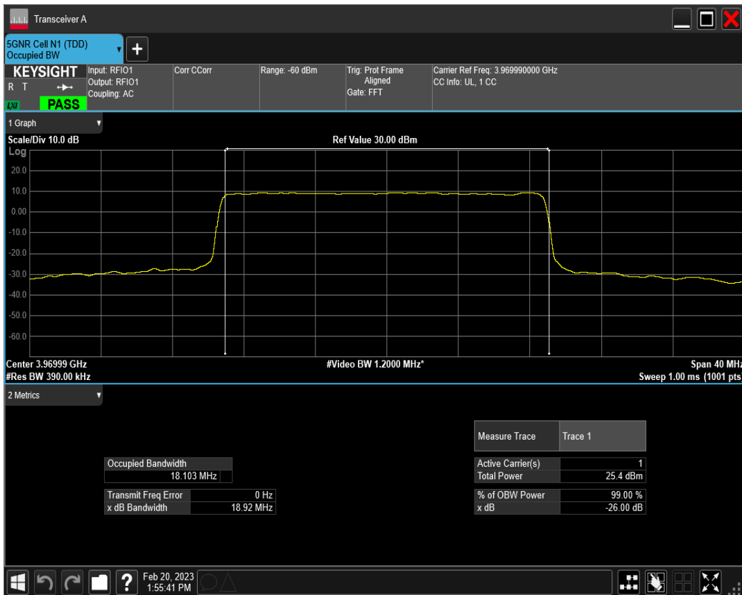
n77(3700-3980) SCS=30kHz DFT_QAM16 BW=20MHz Channel=664666 RB=50@0
