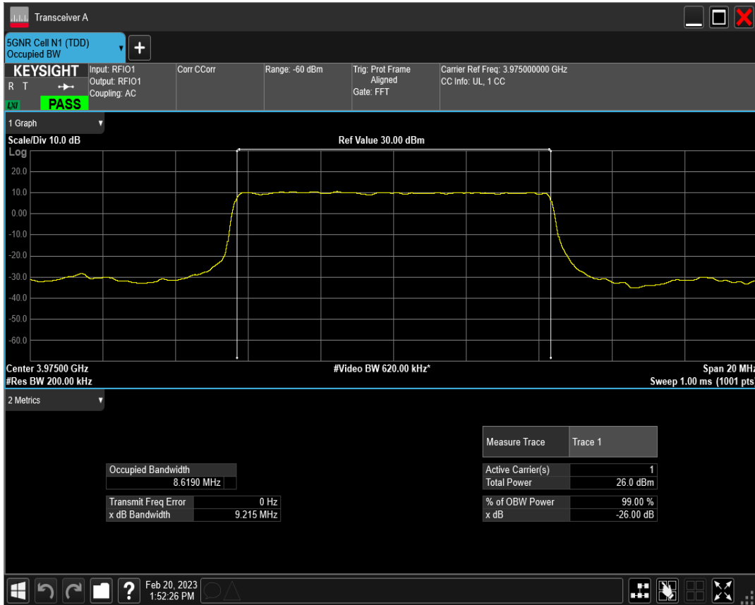
n77(3700-3980) SCS=30kHz DFT_QPSK BW=10MHz Channel=665000 RB=24@0
