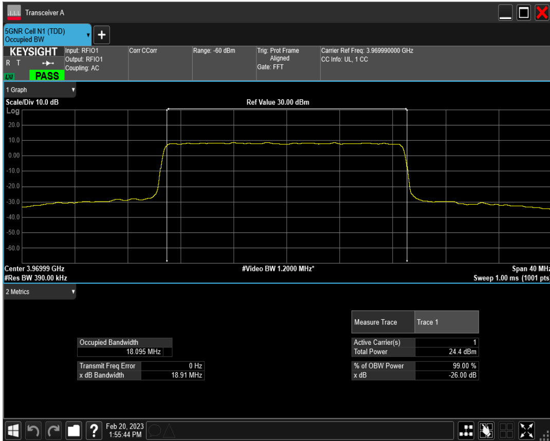
n77(3700-3980) SCS=30kHz DFT_QAM64 BW=20MHz Channel=664666 RB=50@0
