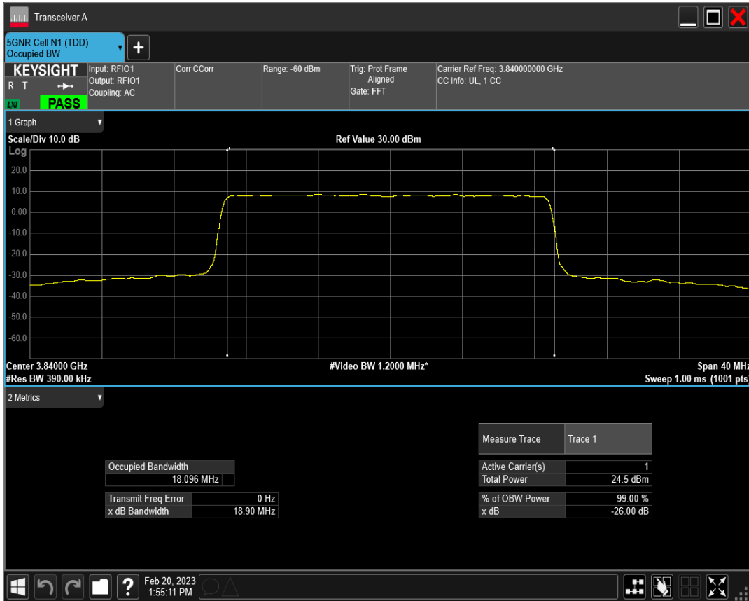
n77(3700-3980) SCS=30kHz DFT_QAM64 BW=20MHz Channel=656000 RB=50@0
