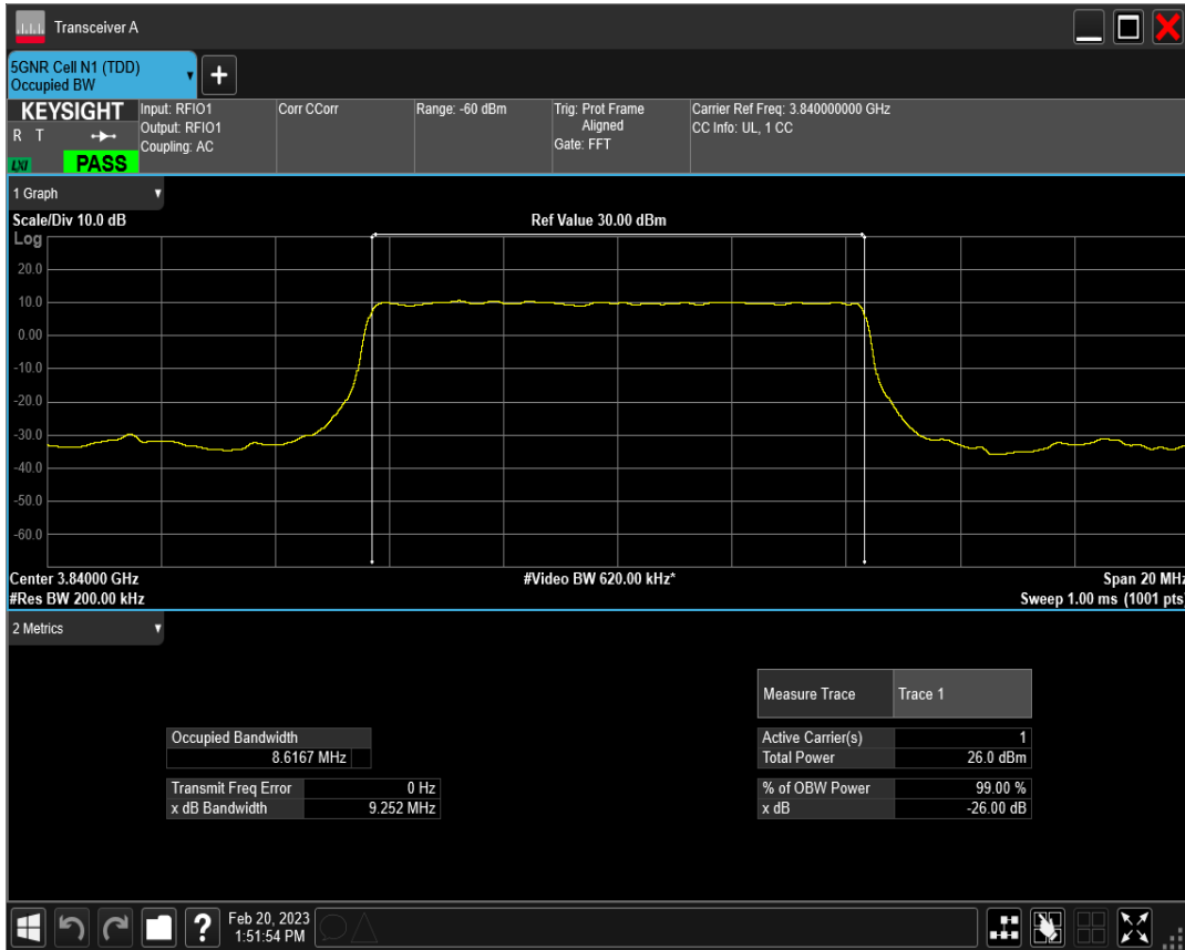
n77(3700-3980) SCS=30kHz DFT_QPSK BW=10MHz Channel=656000 RB=24@0
