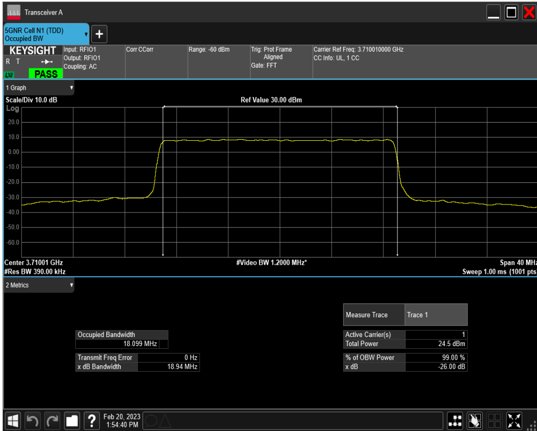
n77(3700-3980) SCS=30kHz DFT_QAM64 BW=20MHz Channel=647334 RB=50@0
