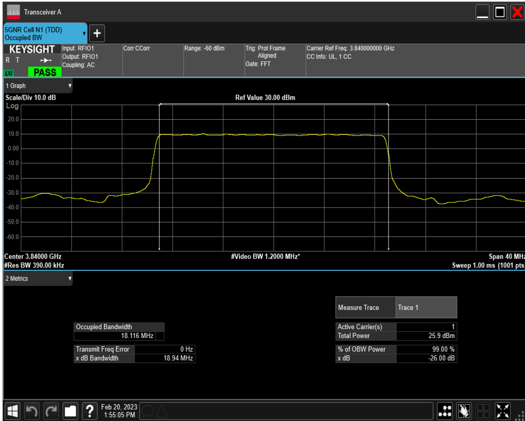
n77(3700-3980) SCS=30kHz DFT_QPSK BW=20MHz Channel=656000 RB=50@0
