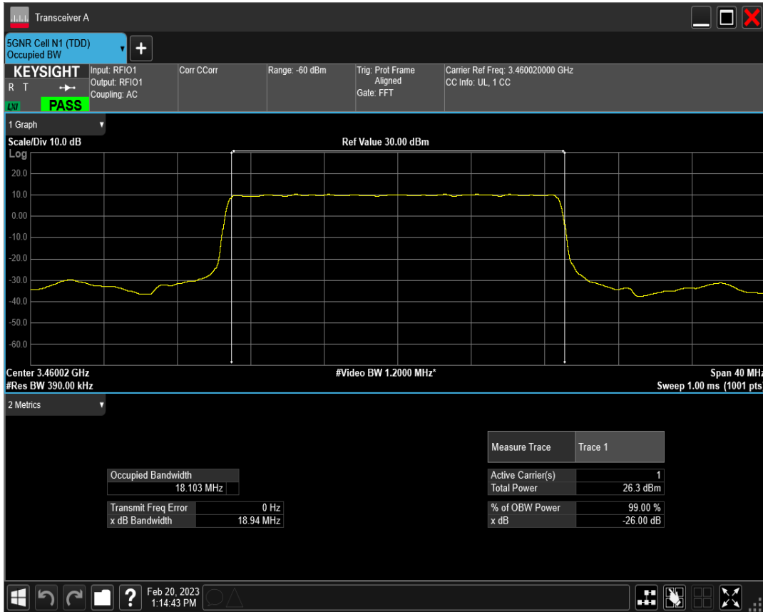
n77(3450-3550) SCS=30kHz DFT_QPSK BW=20MHz Channel=630668 RB=50@0
