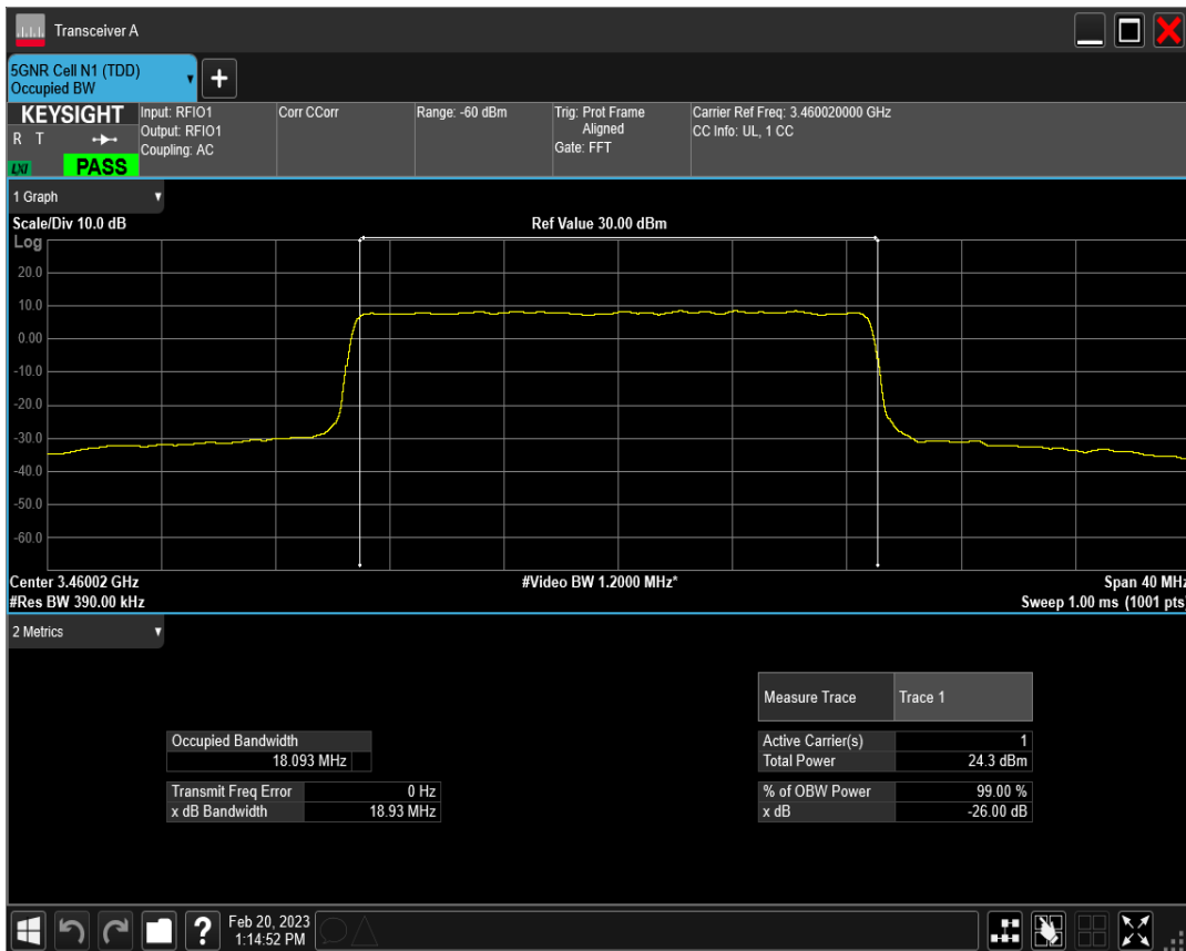
n77(3450-3550) SCS=30kHz DFT_QAM256 BW=20MHz Channel=630668 RB=50@0
