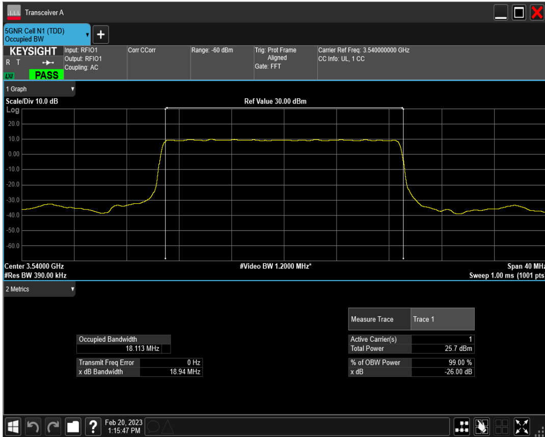
n77(3450-3550) SCS=30kHz DFT_QPSK BW=20MHz Channel=636000 RB=50@0
