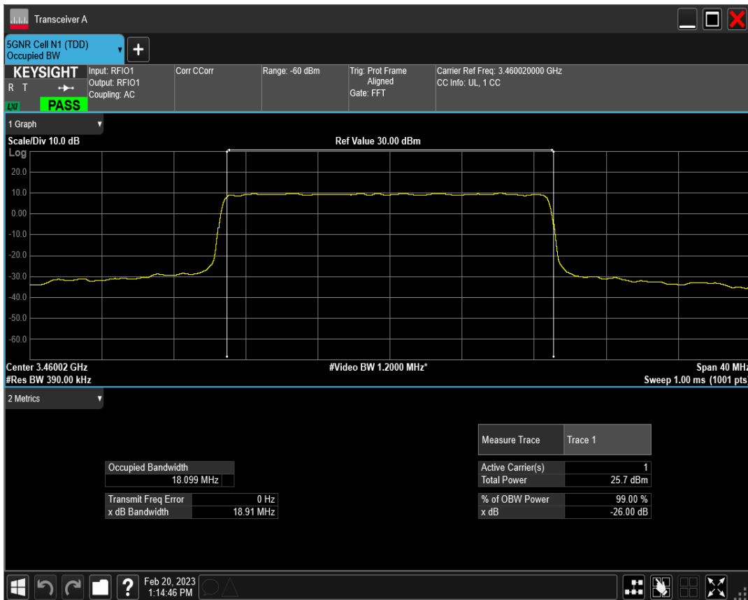
n77(3450-3550) SCS=30kHz DFT_QAM16 BW=20MHz Channel=630668 RB=50@0
