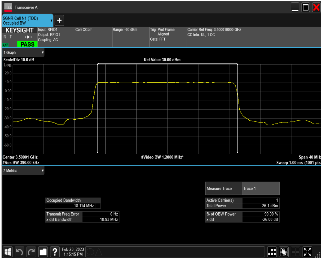
n77(3450-3550) SCS=30kHz DFT_QPSK BW=20MHz Channel=633334 RB=50@0
