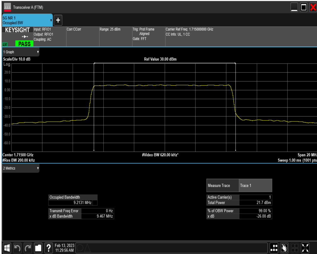
n66 SCS=15kHz DFT_QAM16 BW=10MHz Channel=343000 RB=50@0
