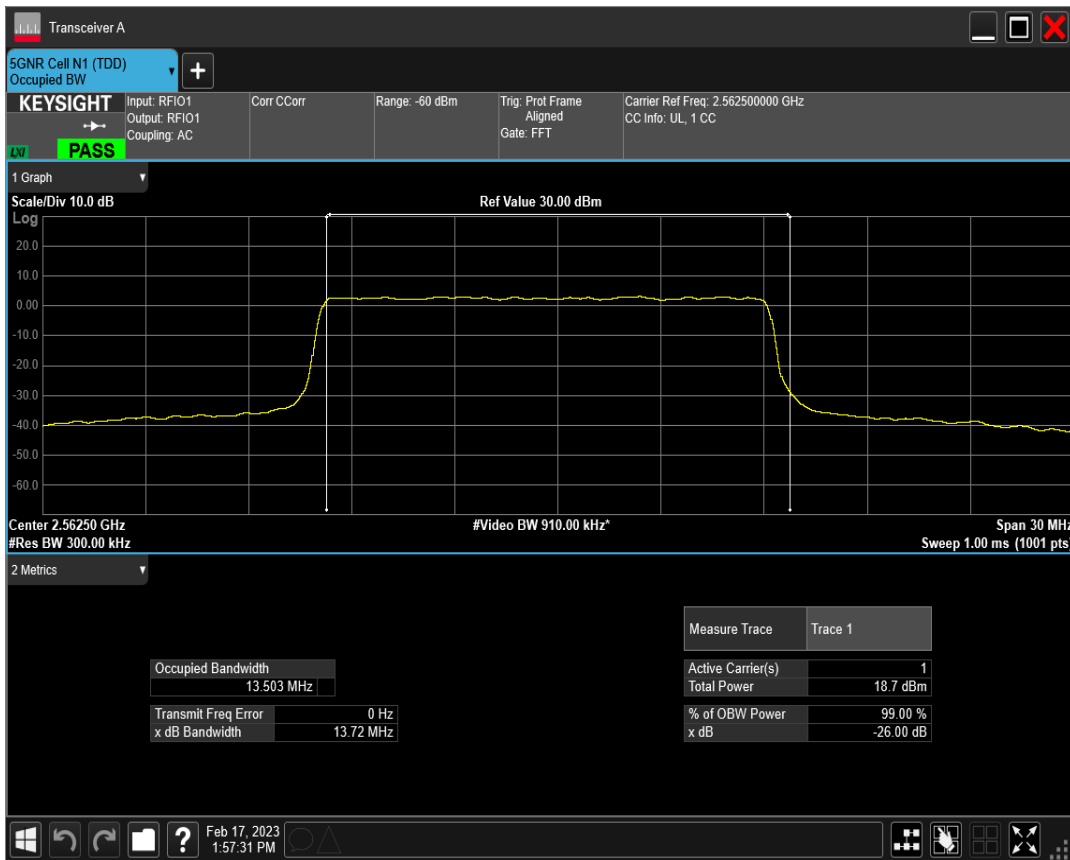
n7 SCS=30kHz CP_QPSK BW=15MHz Channel=512500 RB=38@0
