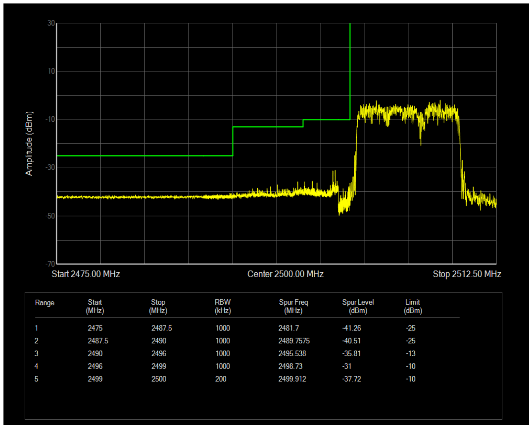
n7 SCS=30kHz DFT_QPSK BW=10MHz Channel=513000 RB=24@0
