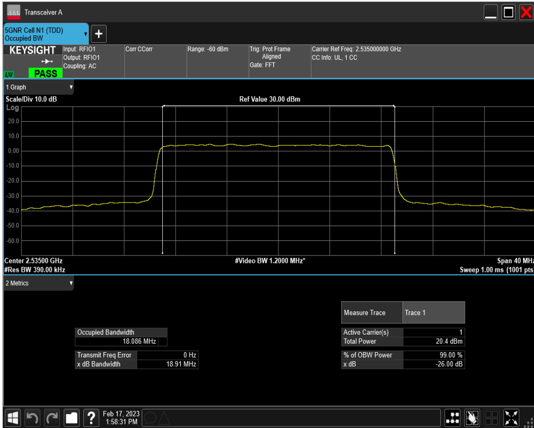
n7 SCS=30kHz DFT_QAM256 BW=20MHz Channel=507000 RB=50@0
