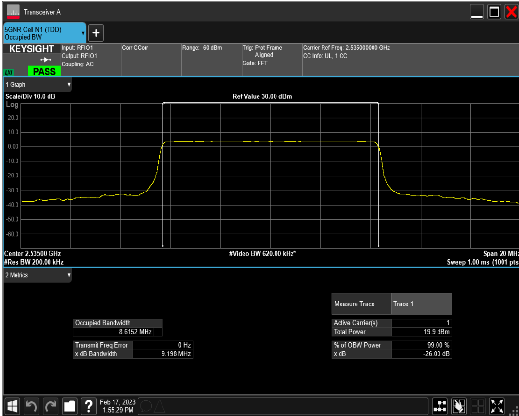
n7 SCS=30kHz DFT_BPSK BW=10MHz Channel=513000 RB=24@0
