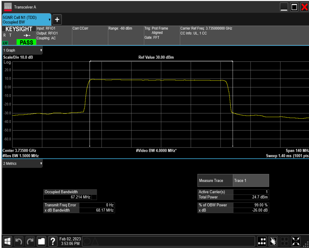
n78(3700-3800) SCS=30kHz CP_QPSK BW=70MHz Channel=649000 RB=189@0
