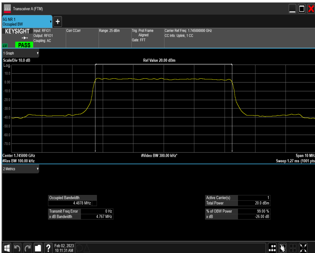
n66 SCS=15kHz DFT_QPSK BW=5MHz Channel=349000 RB=25@0
