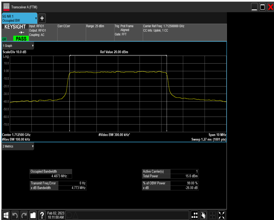
n66 SCS=15kHz CP_QPSK BW=5MHz Channel=342500 RB=25@0
