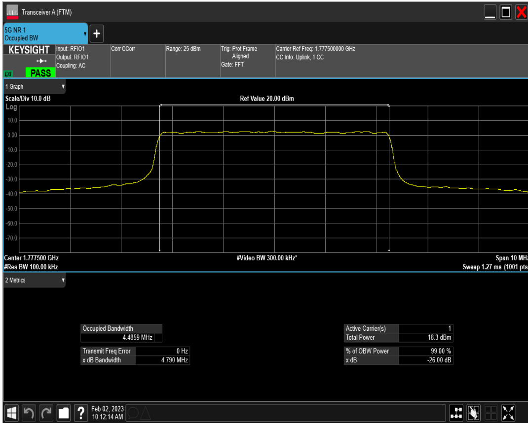
n66 SCS=15kHz DFT_QAM256 BW=5MHz Channel=355500 RB=25@0
