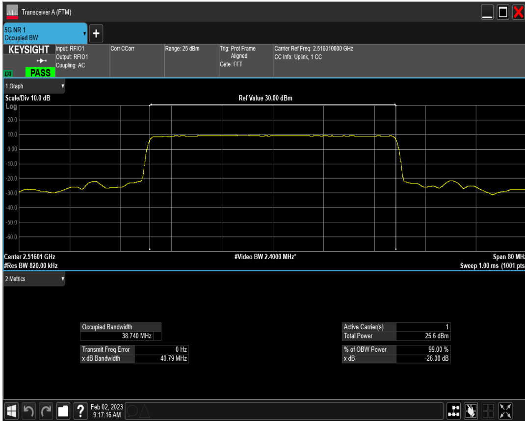
n41 SCS=15kHz DFT_QPSK BW=40MHz Channel=503202 RB=216@0
