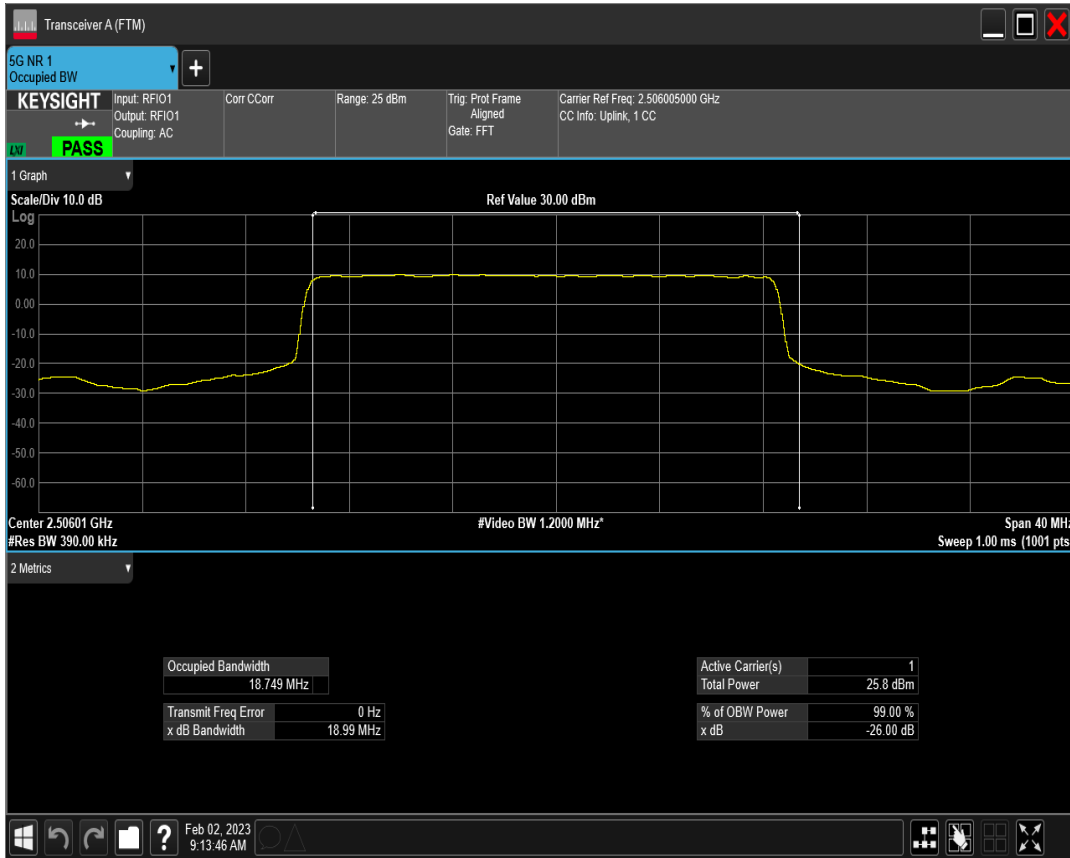
n41 SCS=15kHz DFT_QPSK BW=20MHz Channel=501201 RB=100@0
