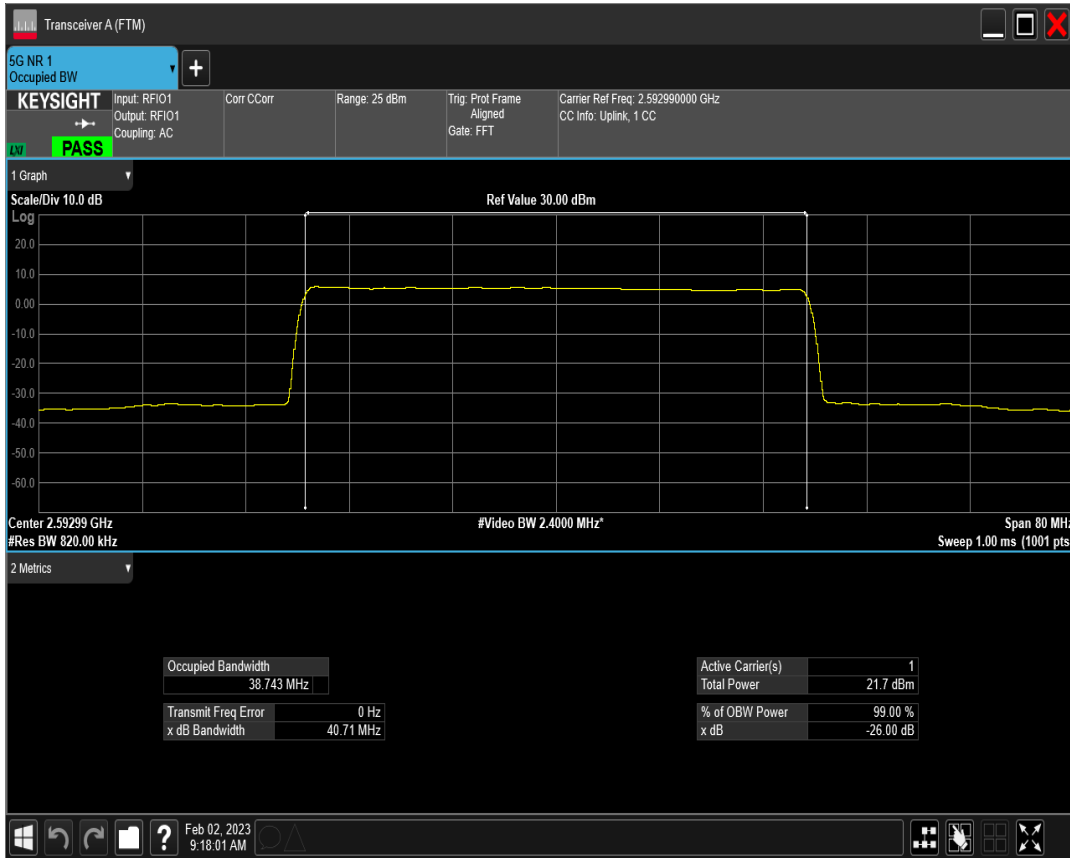
n41 SCS=15kHz CP_QPSK BW=40MHz Channel=518598 RB=216@0
