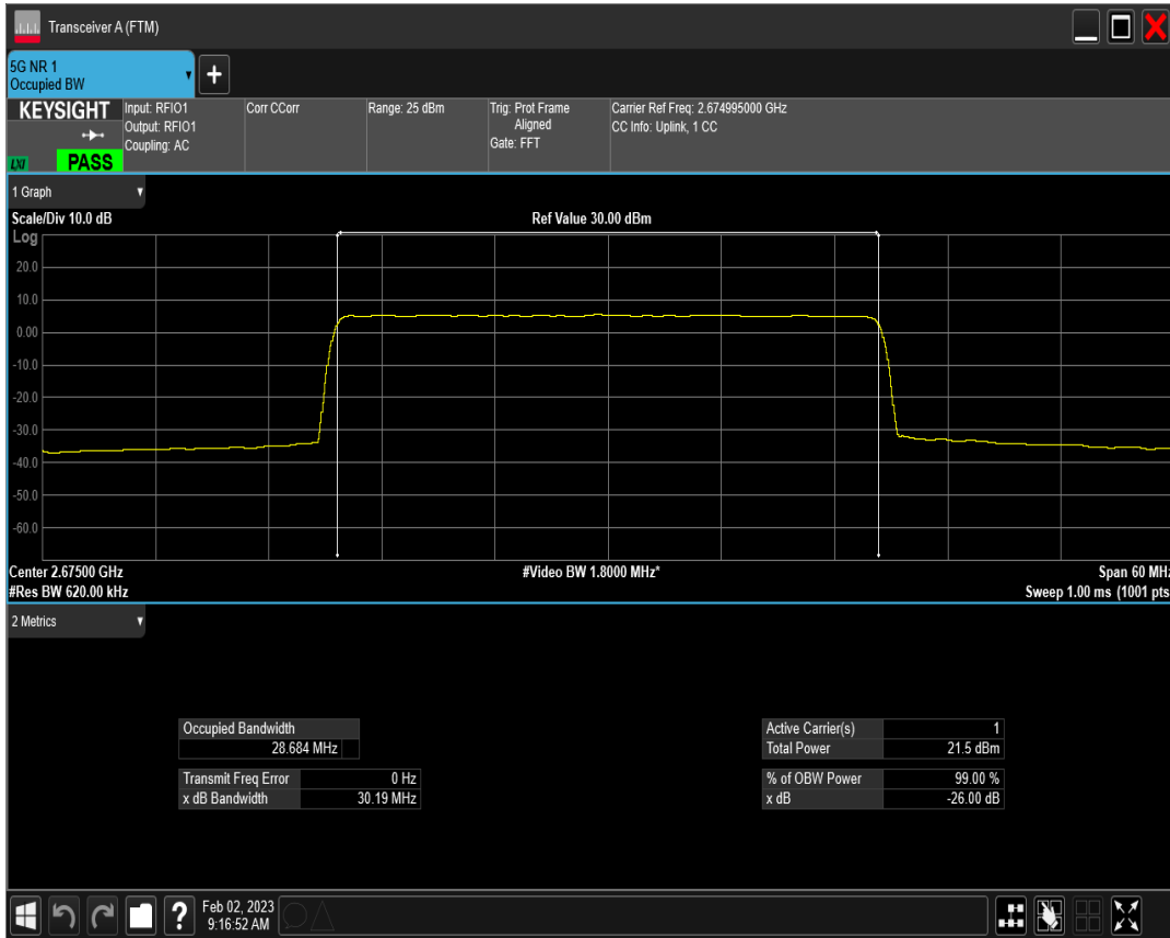
n41 SCS=15kHz CP_QPSK BW=30MHz Channel=534999 RB=160@0
