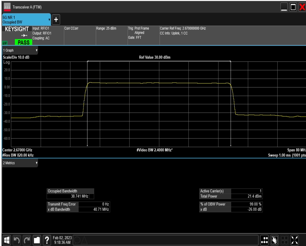
n41 SCS=15kHz CP_QPSK BW=40MHz Channel=534000 RB=216@0
