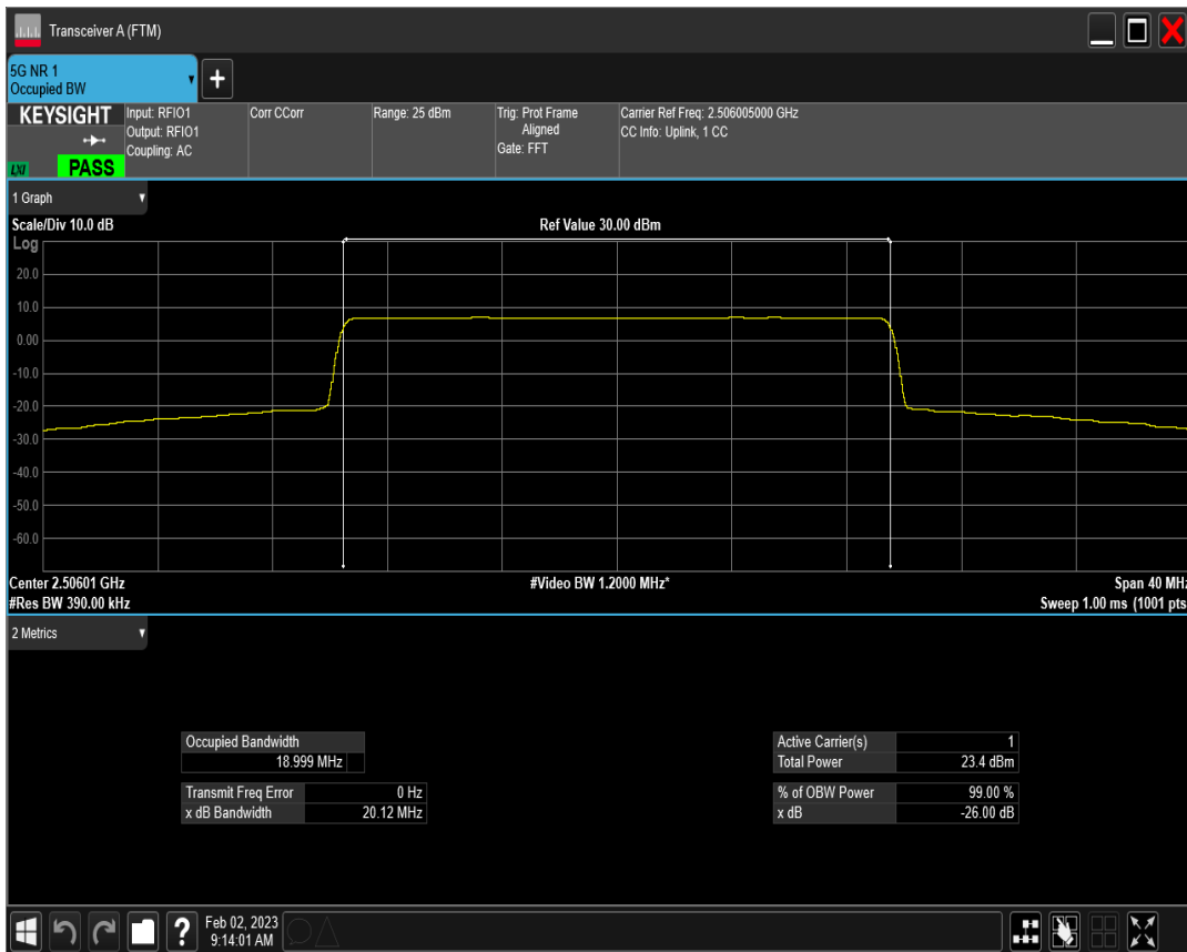
n41 SCS=15kHz DFT_BPSK BW=20MHz Channel=518601 RB=100@0
