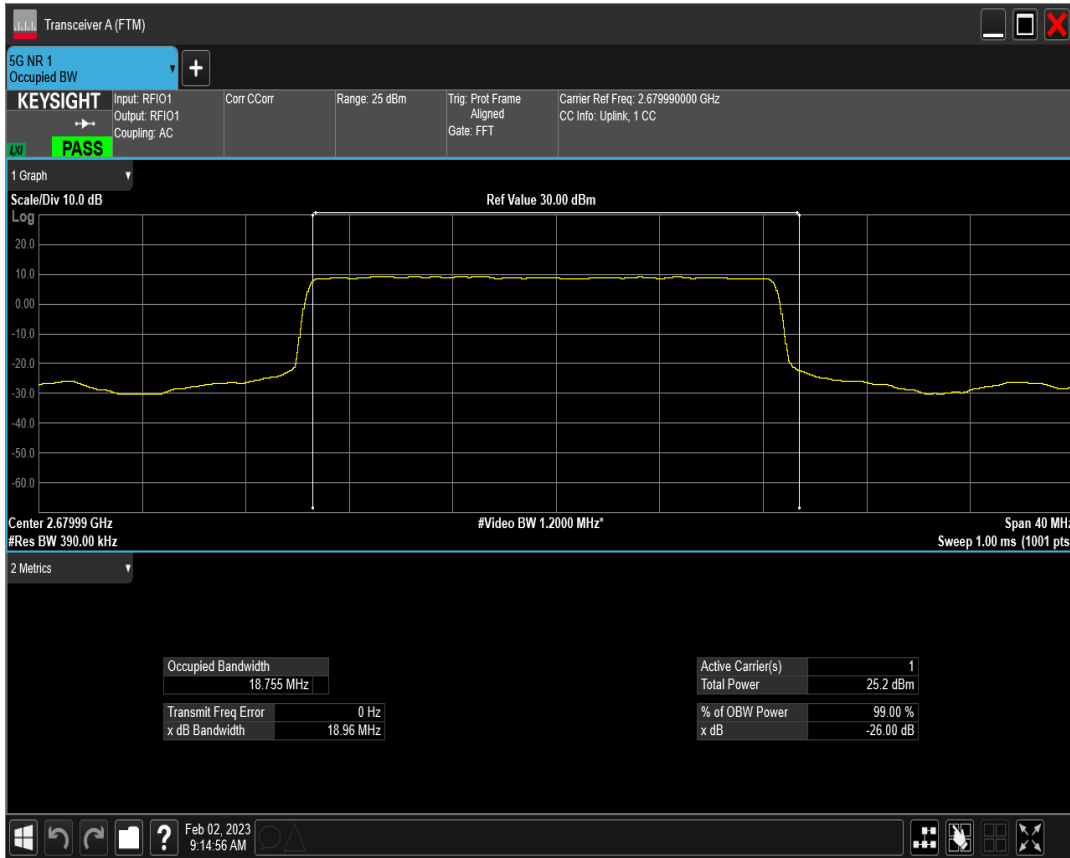
n41 SCS=15kHz DFT_QPSK BW=20MHz Channel=535998 RB=100@0
