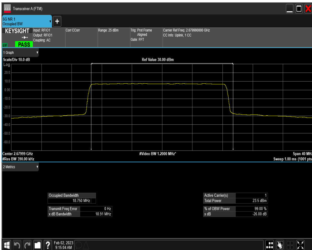
n41 SCS=15kHz DFT_QAM256 BW=20MHz Channel=535998 RB=100@0
