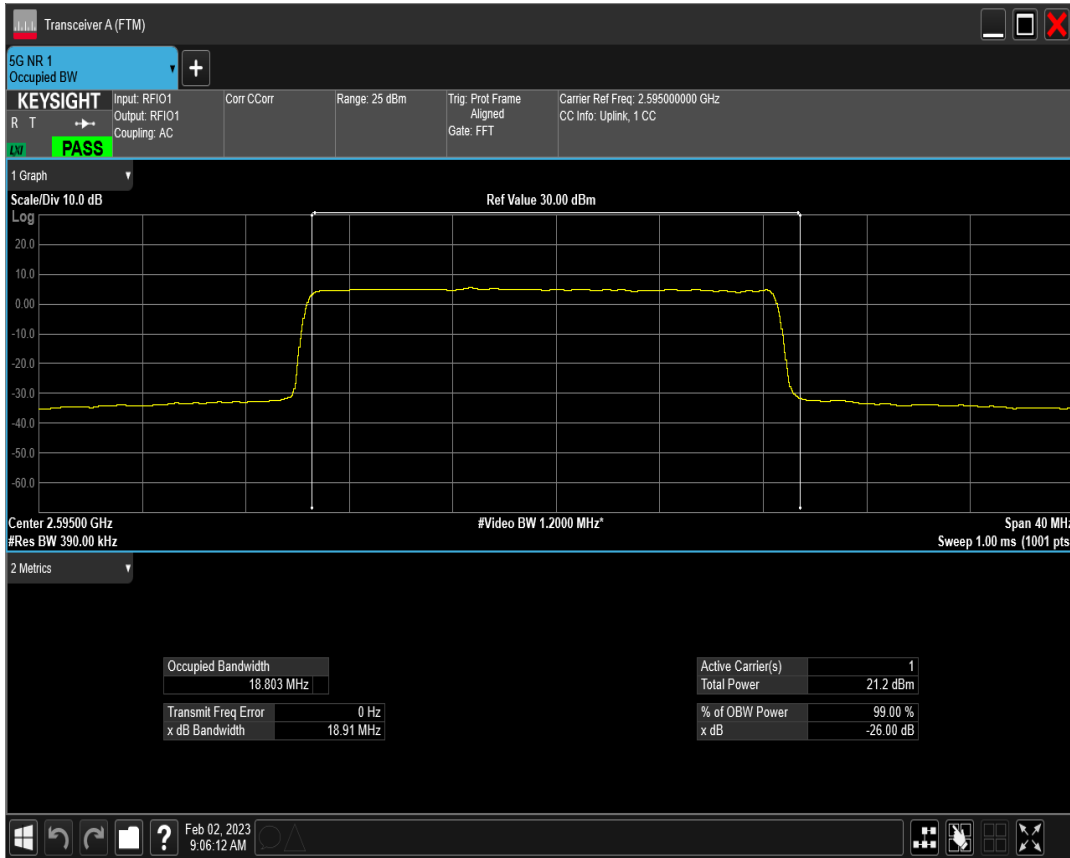
n38 SCS=15kHz DFT_QAM256 BW=20MHz Channel=519000 RB=100@0
