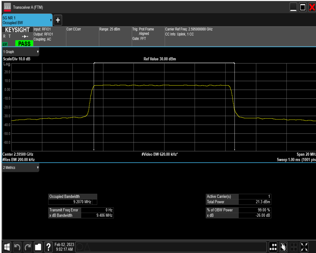
n38 SCS=15kHz DFT_QAM256 BW=10MHz Channel=519000 RB=50@0
