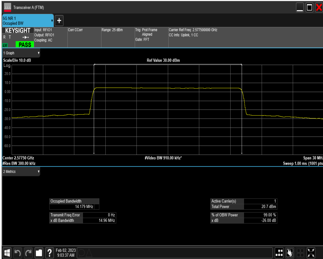
n38 SCS=15kHz DFT_BPSK BW=15MHz Channel=519000 RB=75@0
