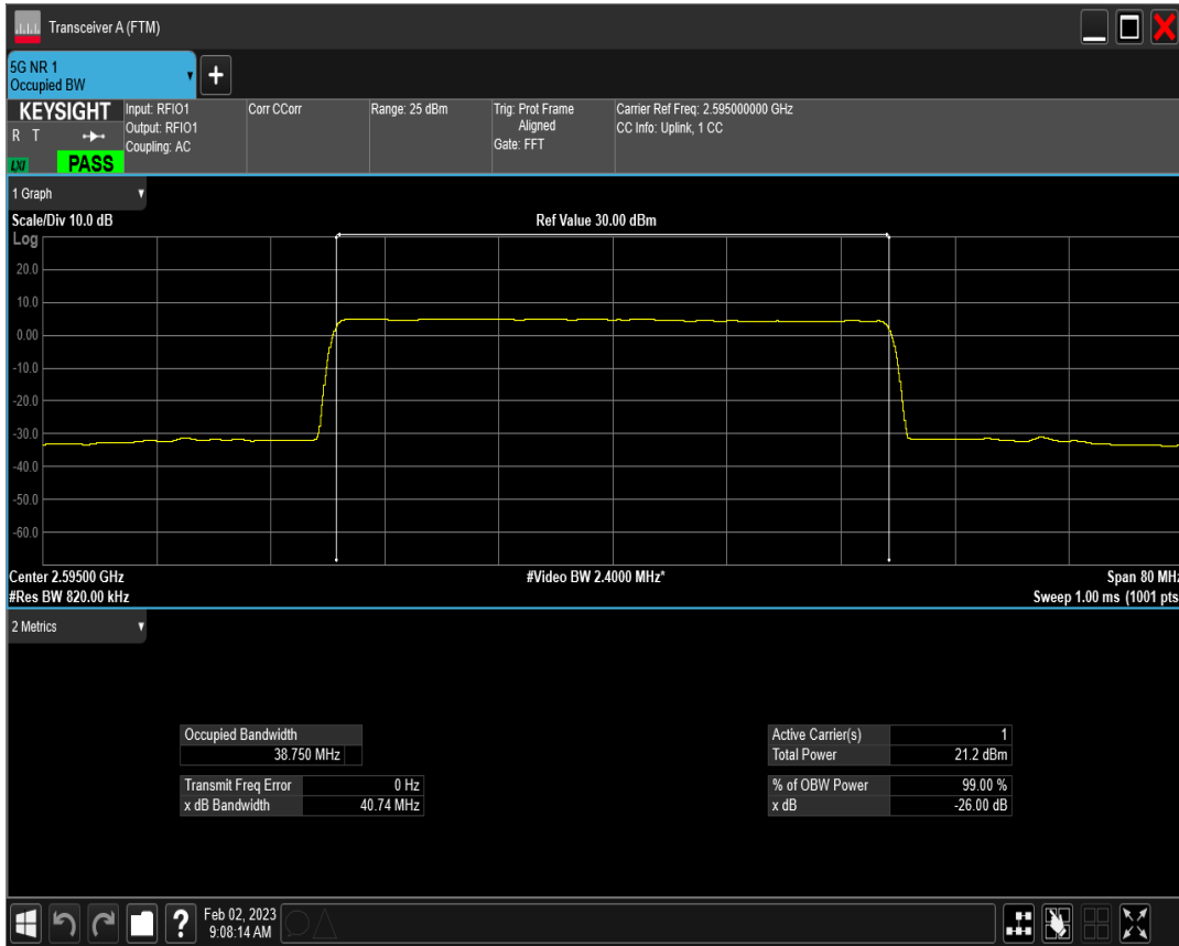
n38 SCS=15kHz DFT_QAM256 BW=40MHz Channel=519000 RB=216@0
