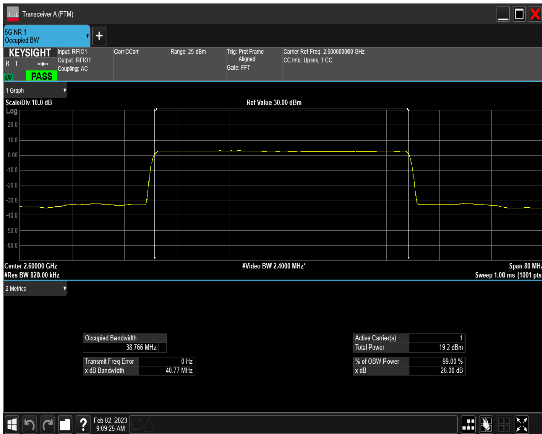
n38 SCS=15kHz CP_QPSK BW=40MHz Channel=520000 RB=216@0
