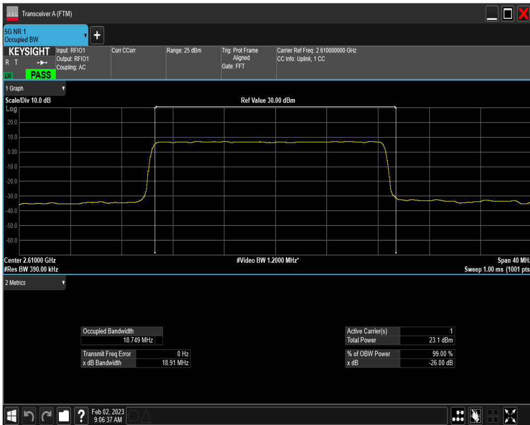
n38 SCS=15kHz DFT_QPSK BW=20MHz Channel=522000 RB=100@0
