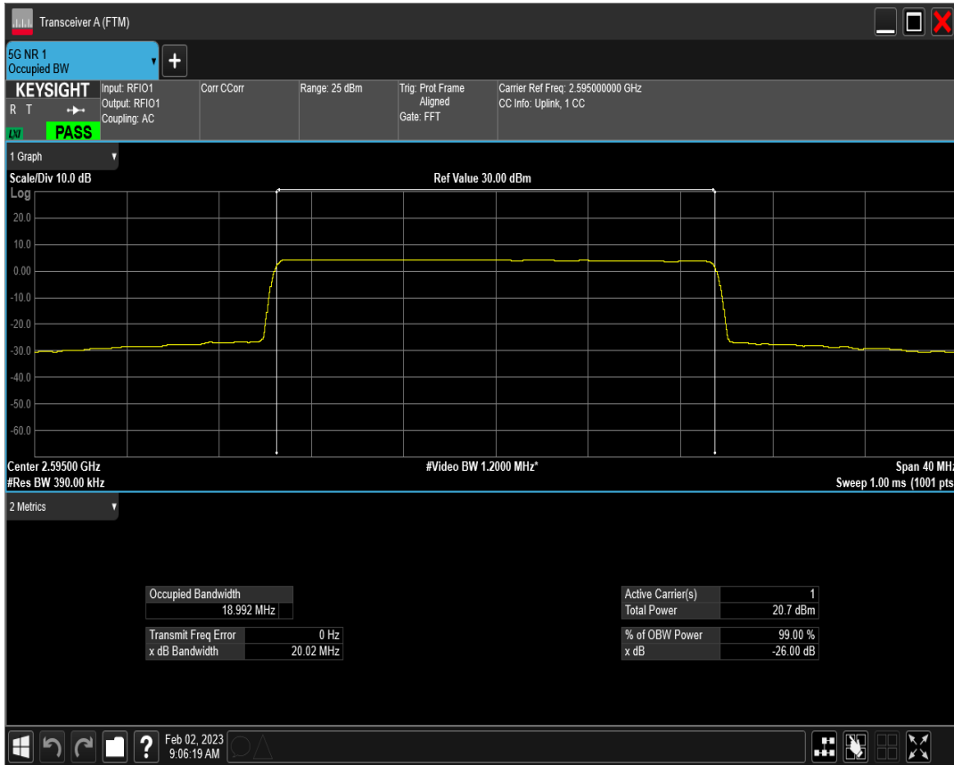
n38 SCS=15kHz DFT_BPSK BW=20MHz Channel=522000 RB=100@0
