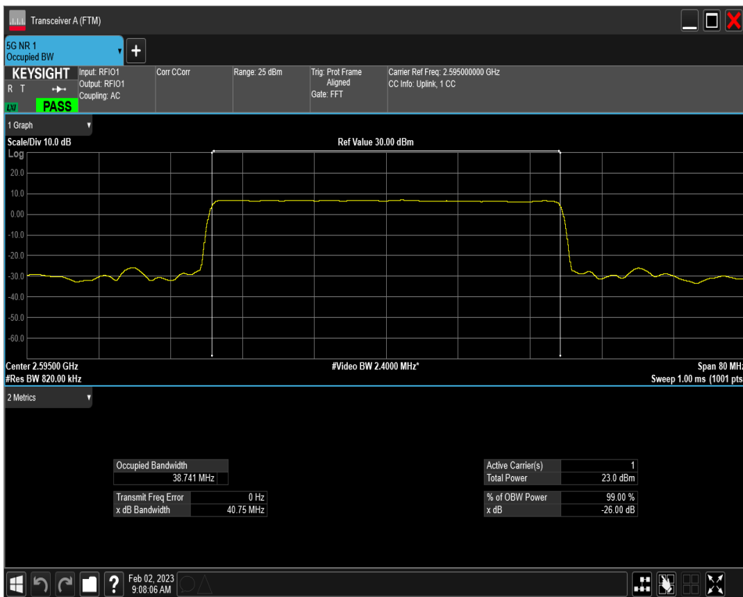
n38 SCS=15kHz DFT_QPSK BW=40MHz Channel=519000 RB=216@0
