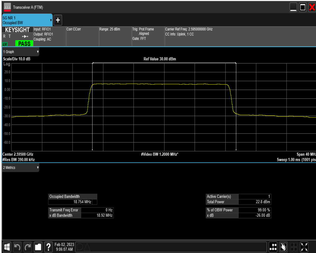
n38 SCS=15kHz DFT_QAM16 BW=20MHz Channel=519000 RB=100@0
