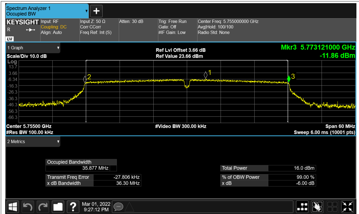
-6dB Bandwidth NVNT n40 5795MHz Ant1
