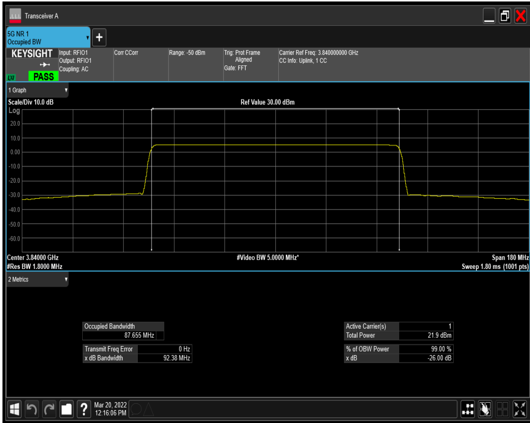
n77(3700-3980) SCS=30kHz DFT_BPSK BW=90MHz Channel=662332 RB=240@0
