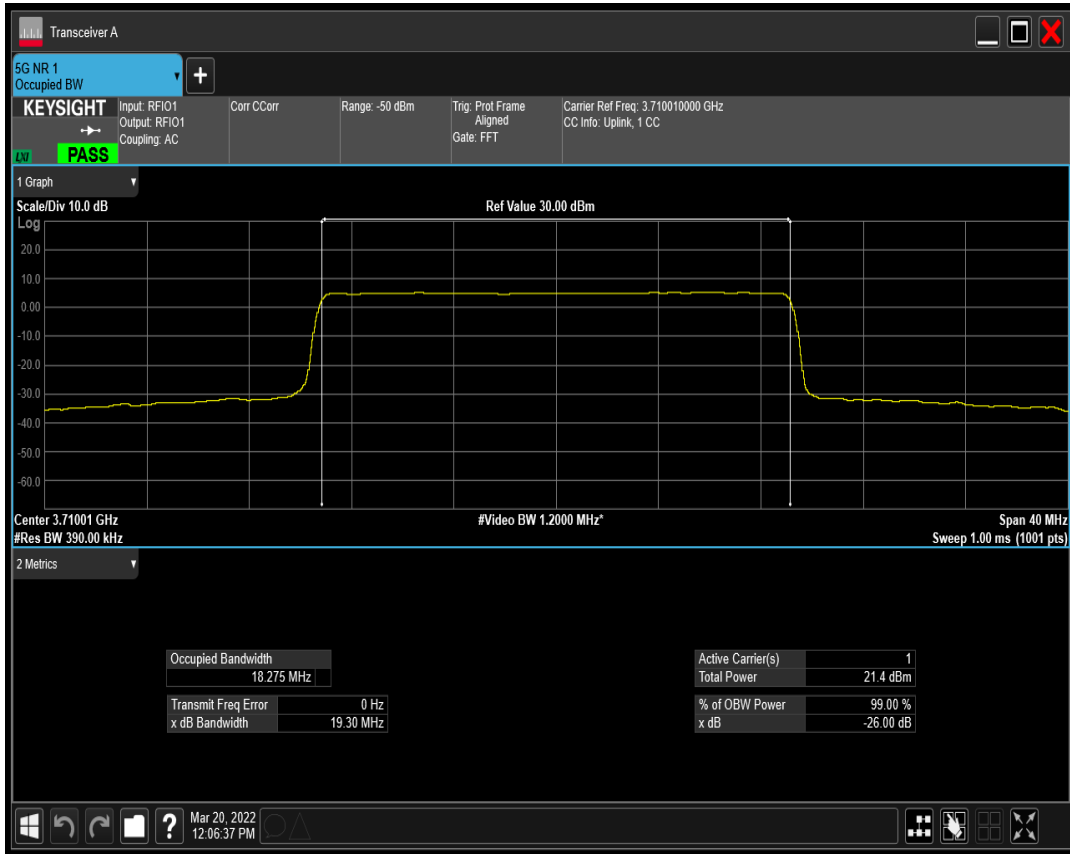
n77(3700-3980) SCS=30kHz DFT_BPSK BW=20MHz Channel=656000 RB=50@0
