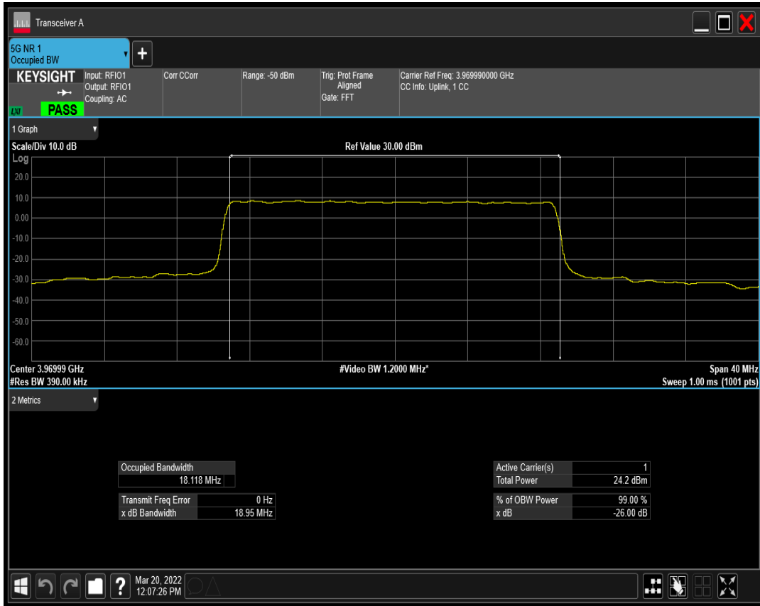
n77(3700-3980) SCS=30kHz DFT_QAM16 BW=20MHz Channel=664666 RB=50@0
