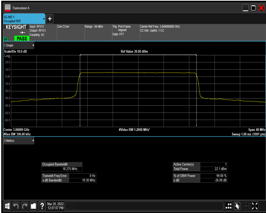
n77(3700-3980) SCS=30kHz DFT_BPSK BW=20MHz Channel=664666 RB=50@0
