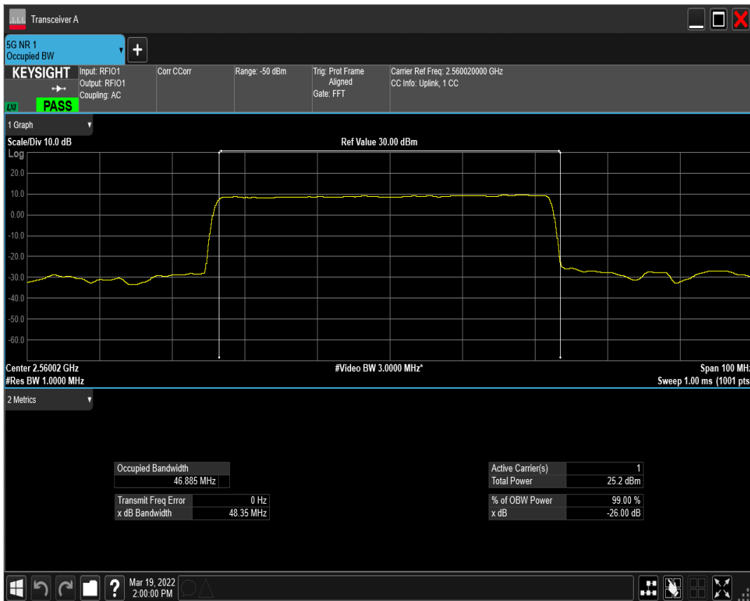
n41(2535-2655) SCS=30kHz DFT_QPSK BW=50MHz Channel=512004 RB=128@0
