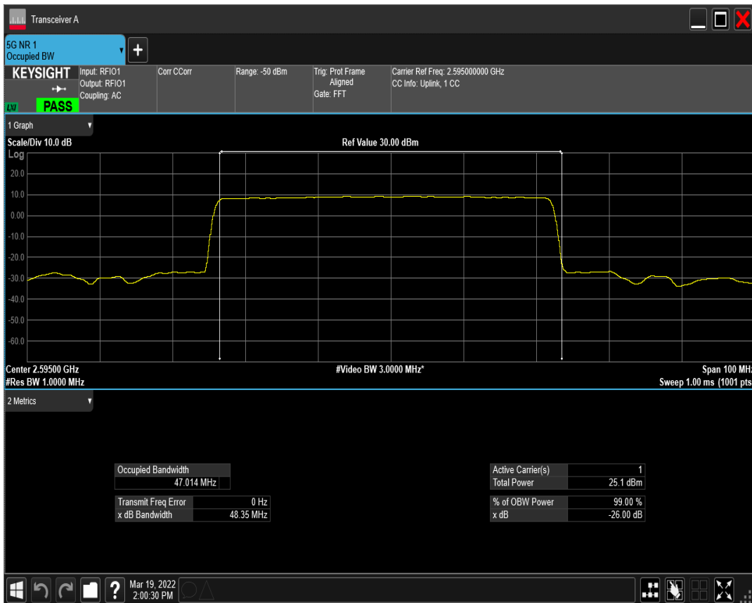
n41(2535-2655) SCS=30kHz DFT_QPSK BW=50MHz Channel=519000 RB=128@0
