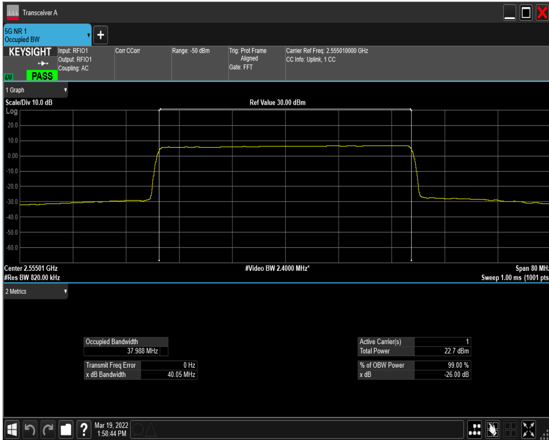
n41(2535-2655) SCS=30kHz DFT_BPSK BW=40MHz Channel=519000 RB=100@0
