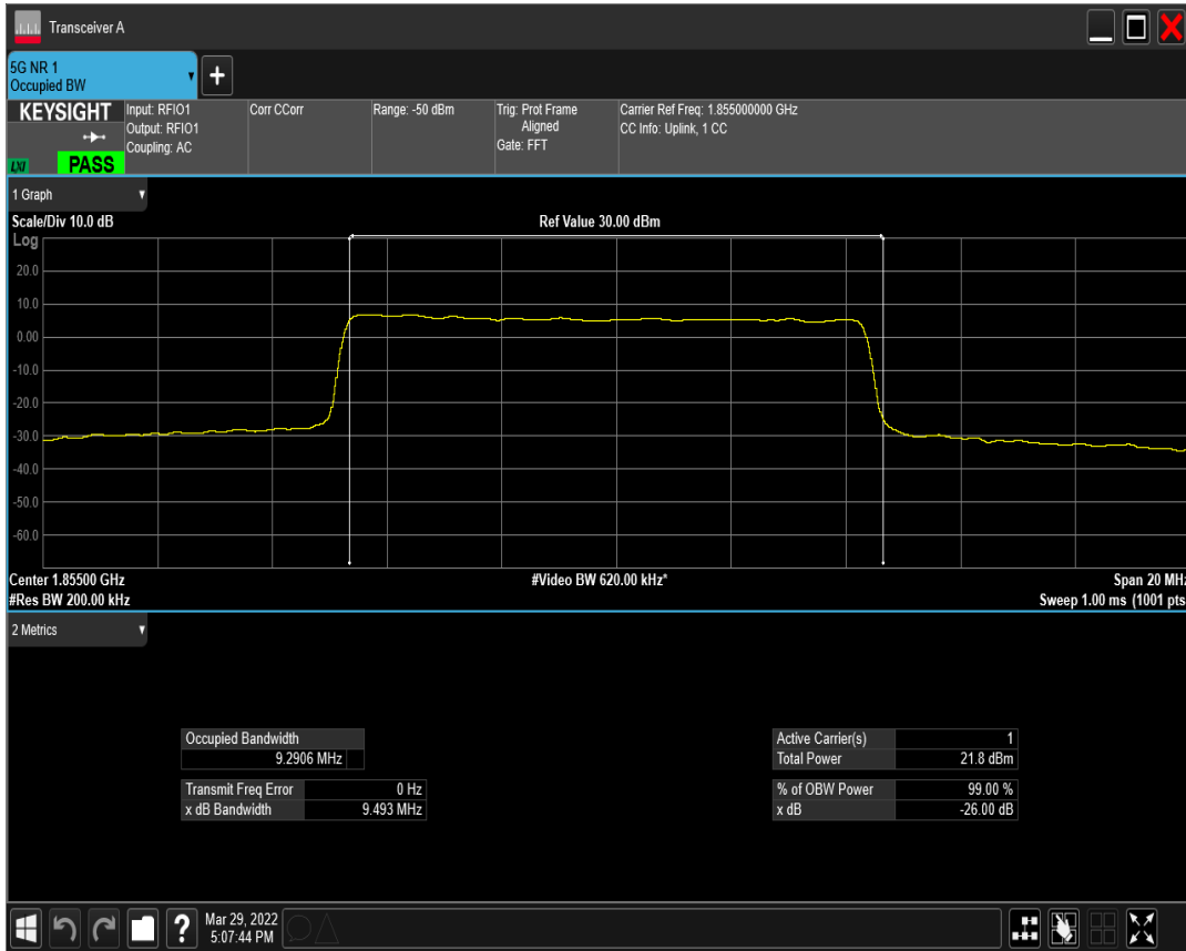
n2 SCS=15kHz DFT_QAM64 BW=10MHz Channel=371000 RB=50@0
