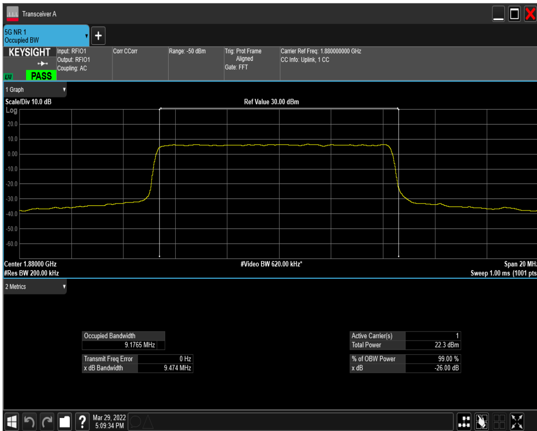
n2 SCS=15kHz DFT_QAM16 BW=10MHz Channel=376000 RB=50@0
