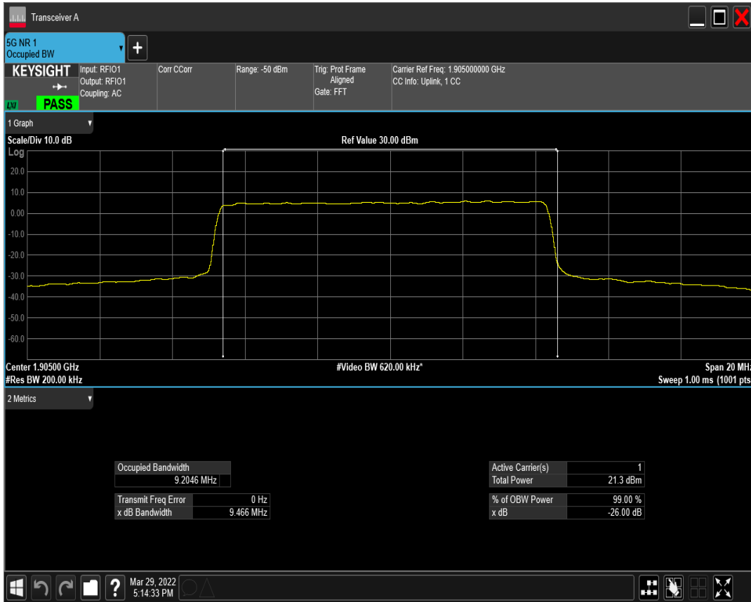
n2 SCS=15kHz DFT_QAM64 BW=10MHz Channel=381000 RB=50@0
