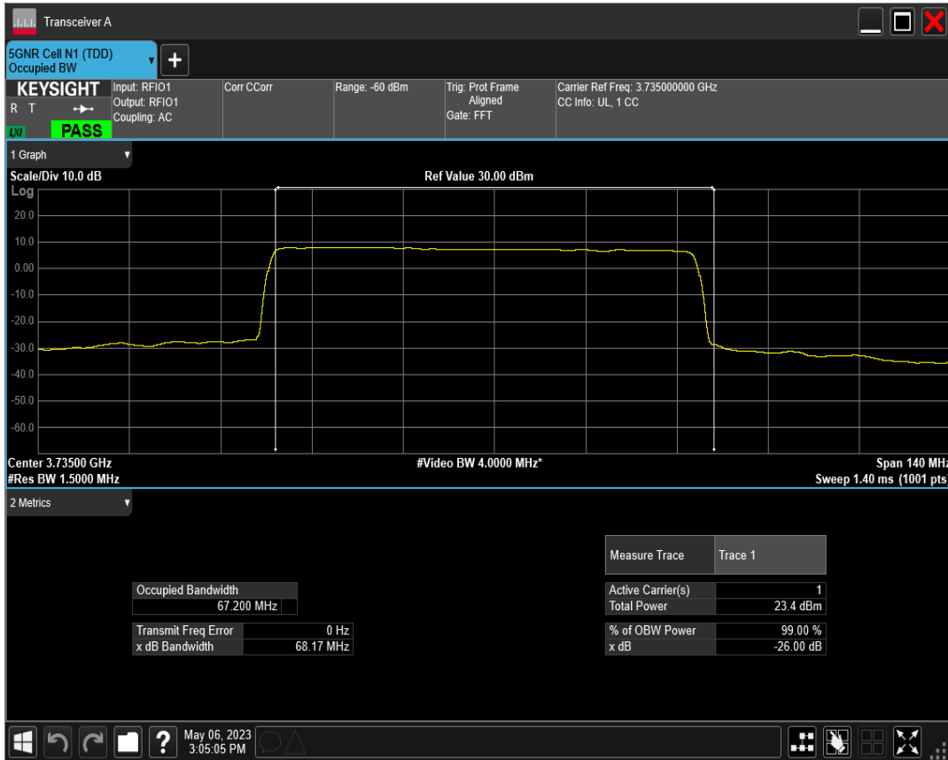
n78(3700-3800) SCS=30kHz CP_QPSK BW=70MHz Channel=649000 RB=189@0
