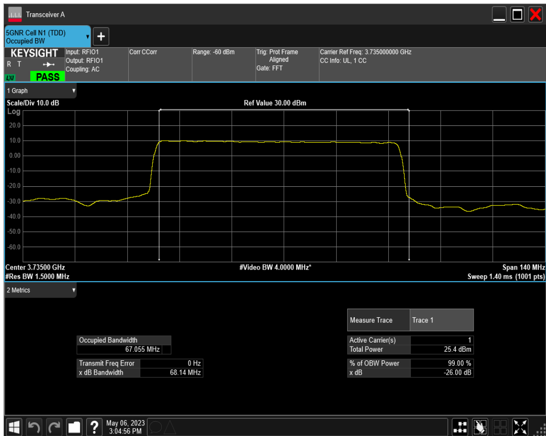
n78(3700-3800) SCS=30kHz DFT_QPSK BW=70MHz Channel=649000 RB=180@0
