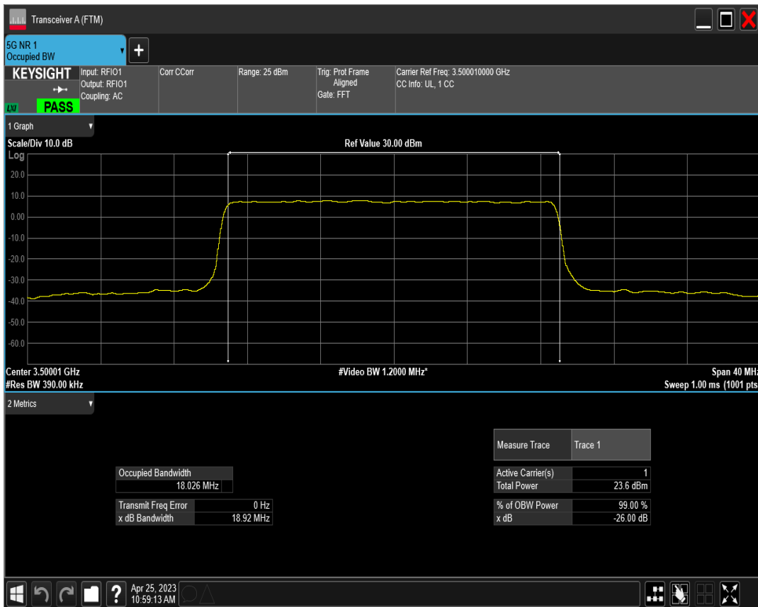
n77(3450-3550) SCS=30kHz DFT_QAM256 BW=20MHz Channel=633334 RB=50@0
