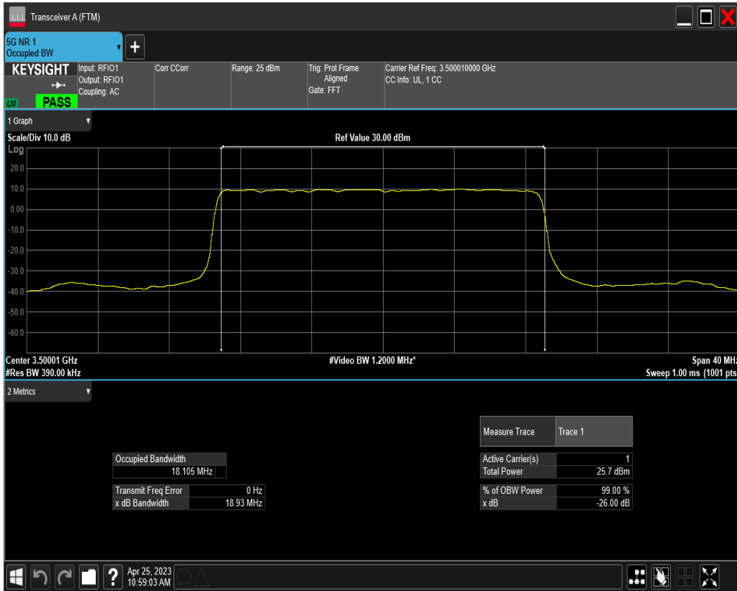
n77(3450-3550) SCS=30kHz DFT_QPSK BW=20MHz Channel=633334 RB=50@0
