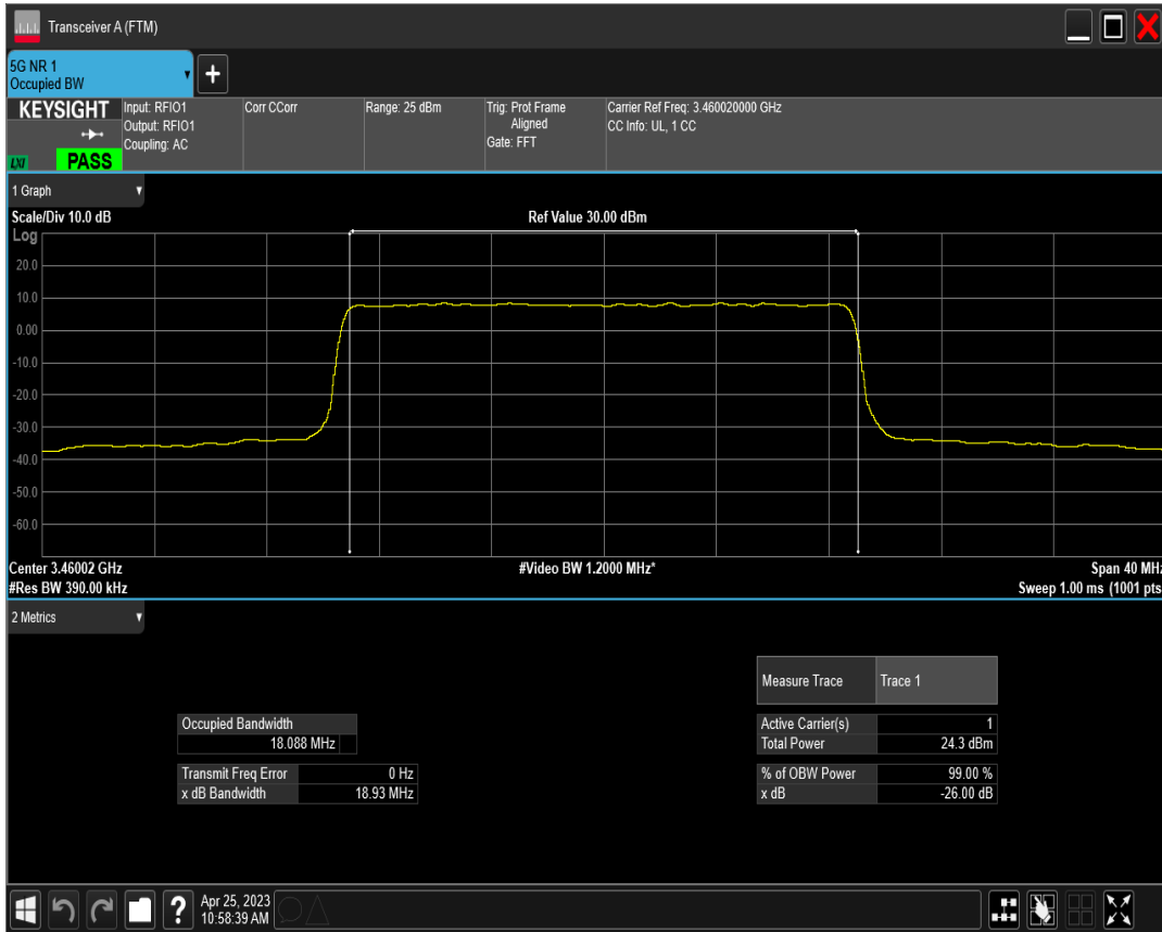
n77(3450-3550) SCS=30kHz DFT_QAM64 BW=20MHz Channel=630668 RB=50@0
