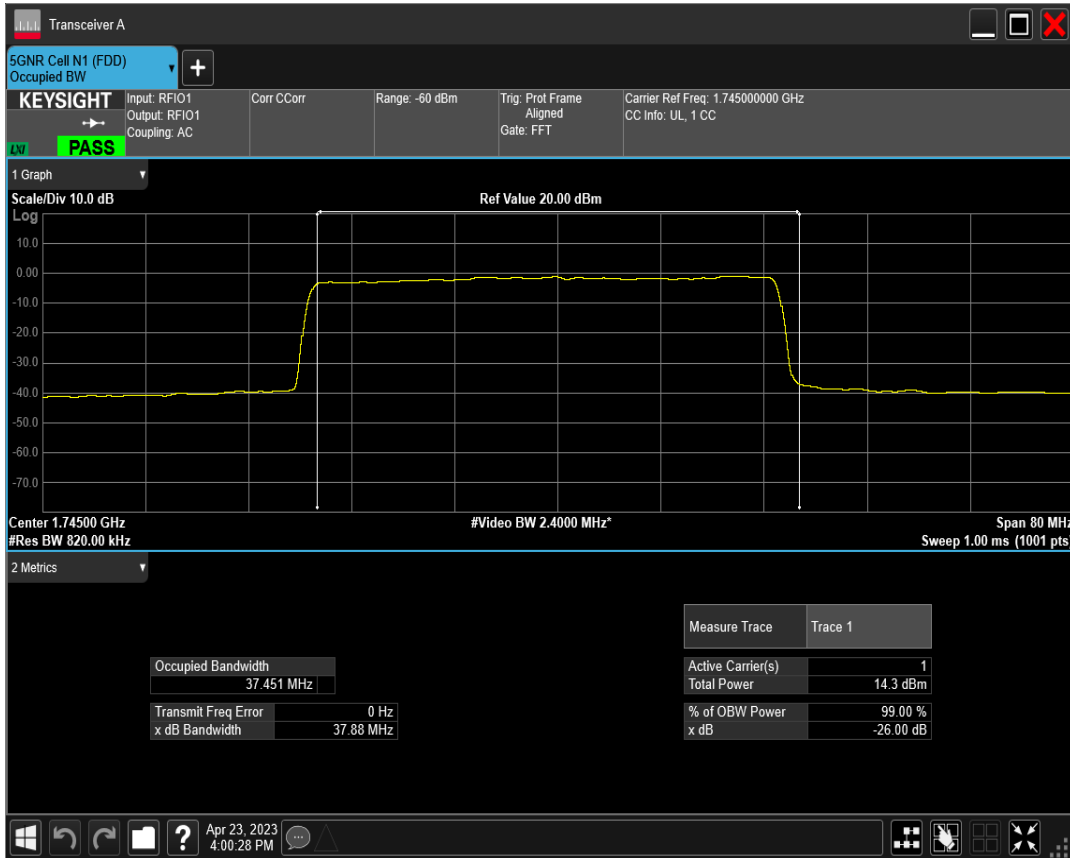
n66 SCS=30kHz CP_QPSK BW=40MHz Channel=349000 RB=106@0
