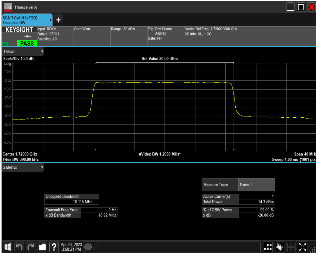
n66 SCS=30kHz CP_QPSK BW=20MHz Channel=344000 RB=51 @0
