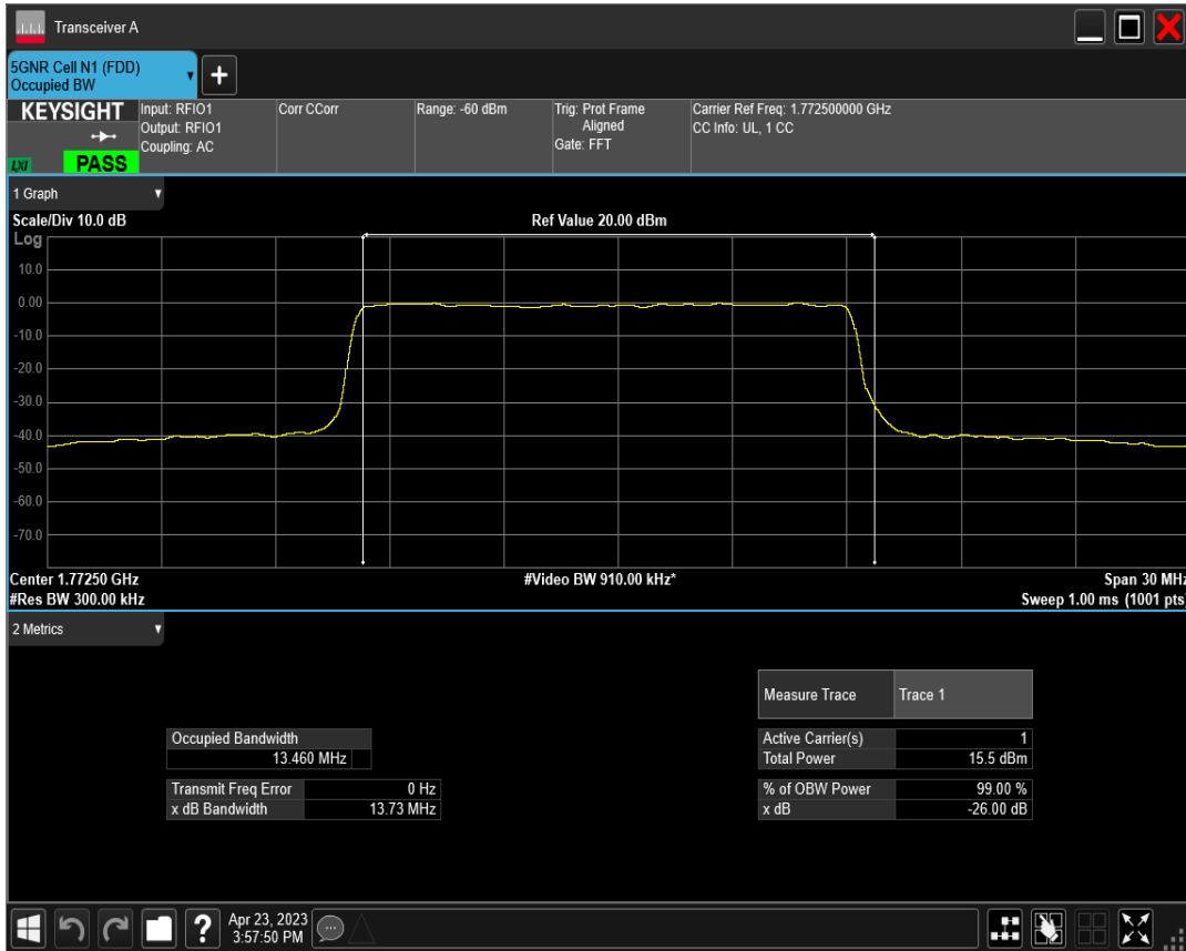
n66 SCS=30kHz CP_QPSK BW=15MHz Channel=354500 RB=38@0
