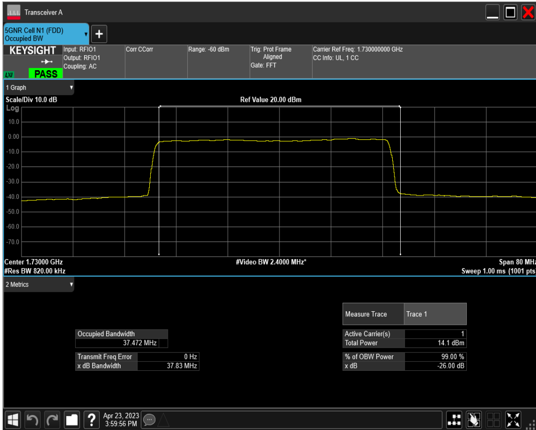
n66 SCS=30kHz CP_QPSK BW=40MHz Channel=346000 RB=106@0
