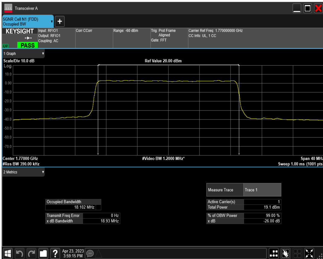
n66 SCS=30kHz DFT_QAM16 BW=20MHz Channel=354000 RB=50@0
