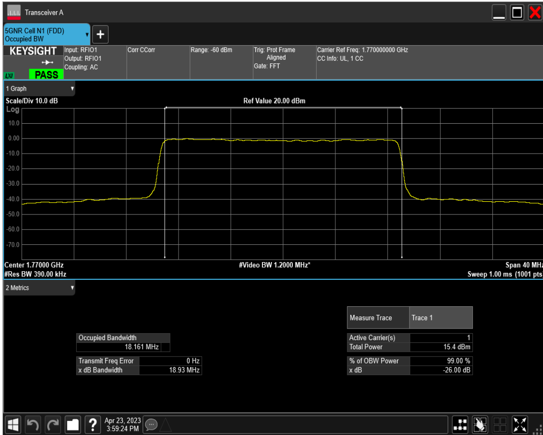
n66 SCS=30kHz CP_QPSK BW=20MHz Channel=354000 RB=51@0
