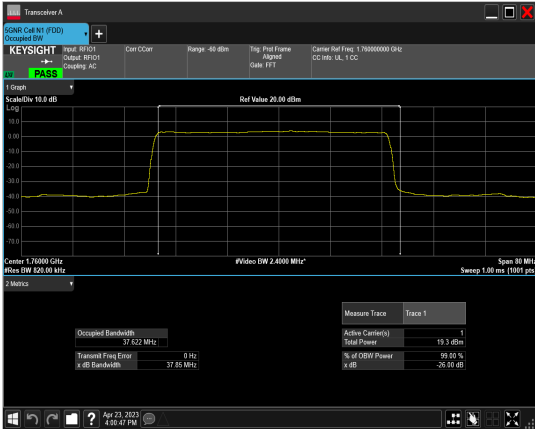
n66 SCS=30kHz DFT_QPSK BW=40MHz Channel=352000 RB=100@0
