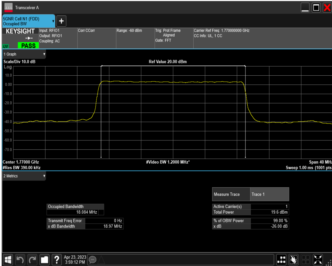
n66 SCS=30kHz DFT_QPSK BW=20MHz Channel=354000 RB=50@0
