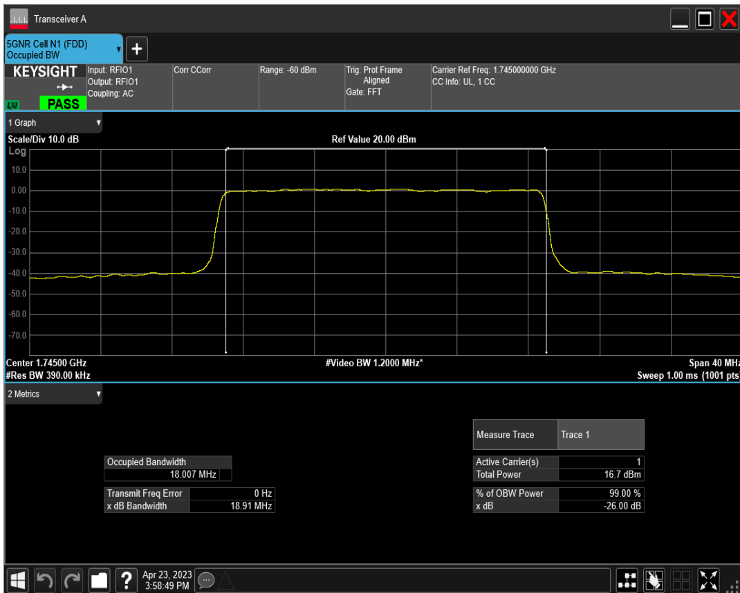
n66 SCS=30kHz DFT_QAM256 BW=20MHz Channel=349000 RB=50@0
