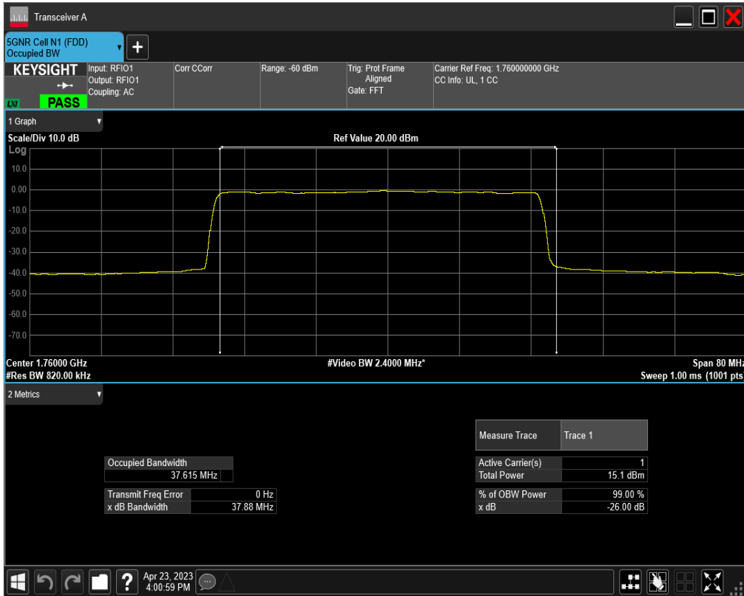
n66 SCS=30kHz CP_QPSK BW=40MHz Channel=352000 RB=106@0
