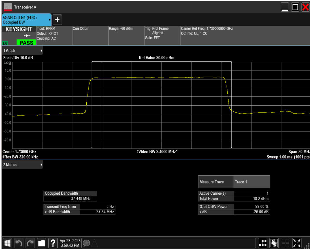
n66 SCS=30kHz DFT_QPSK BW=40MHz Channel=346000 RB=100@0
