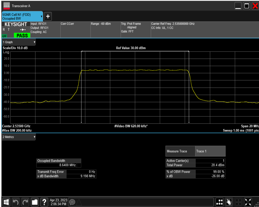
n7 SCS=30kHz DFT_QAM256 BW=10MHz Channel=507000 RB=24@0
