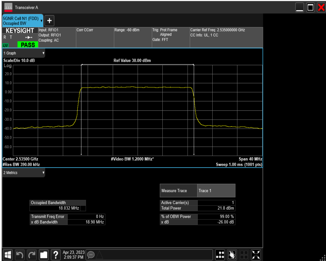
n7 SCS=30kHz DFT_QAM16 BW=20MHz Channel=507000 RB=50@0
