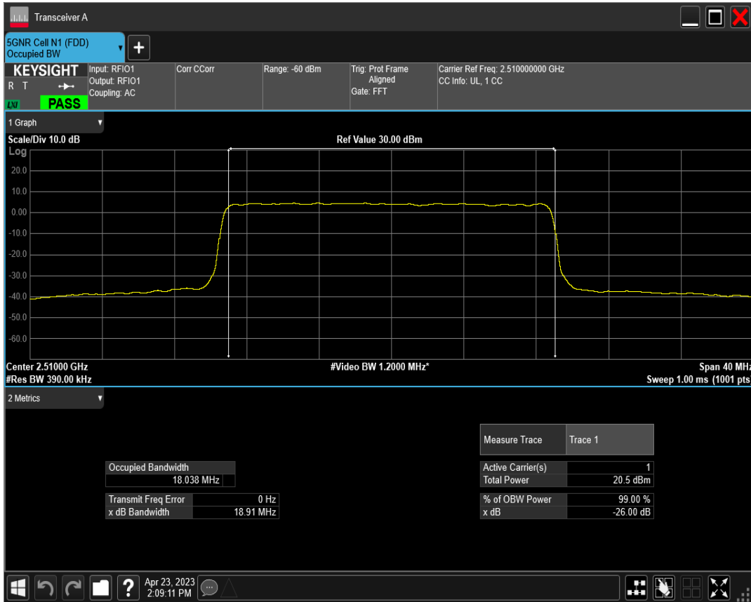
n7 SCS=30kHz DFT_QAM256 BW=20MHz Channel=502000 RB=50@0
