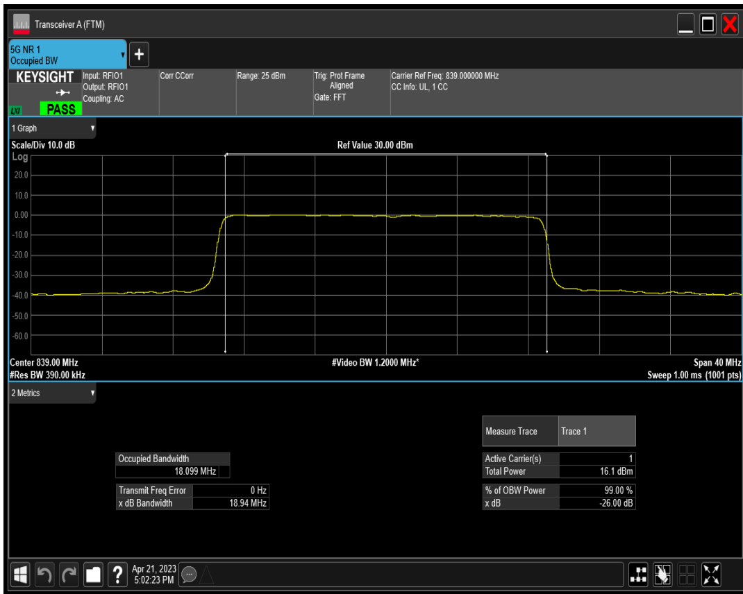
n5 SCS=30kHz CP_QPSK BW=20MHz Channel=167800 RB=51@0
