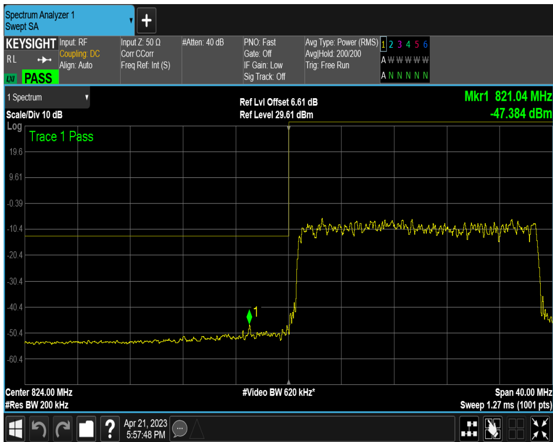
n5 SCS=30kHz DFT_QPSK BW=20MHz Channel=166800 RB=1@0
