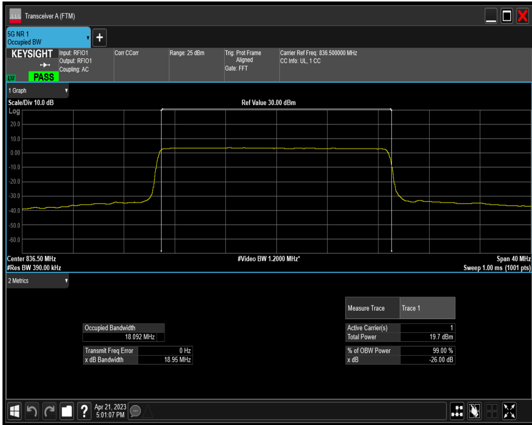
n5 SCS=30kHz DFT_QAM16 BW=20MHz Channel=167300 RB=50@0
