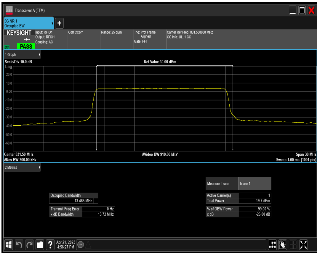
n5 SCS=30kHz DFT_QPSK BW=15MHz Channel=166300 RB=36@0
