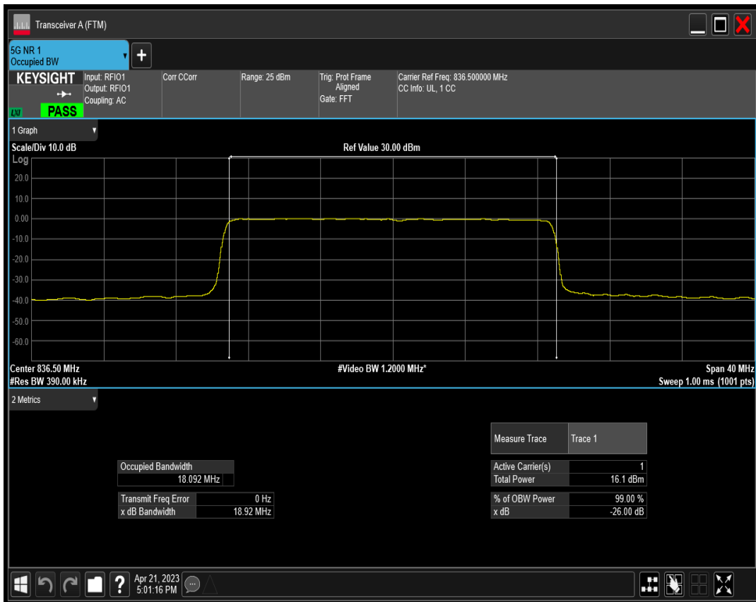
n5 SCS=30kHz CP_QPSK BW=20MHz Channel=167300 RB=51@0
