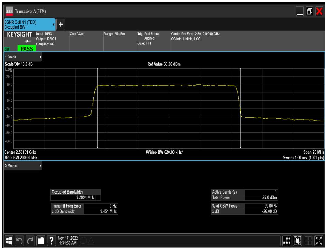
n41 SCS=15kHz DFT_QPSK BW=10MHz Channel=500202 RB=50@0
