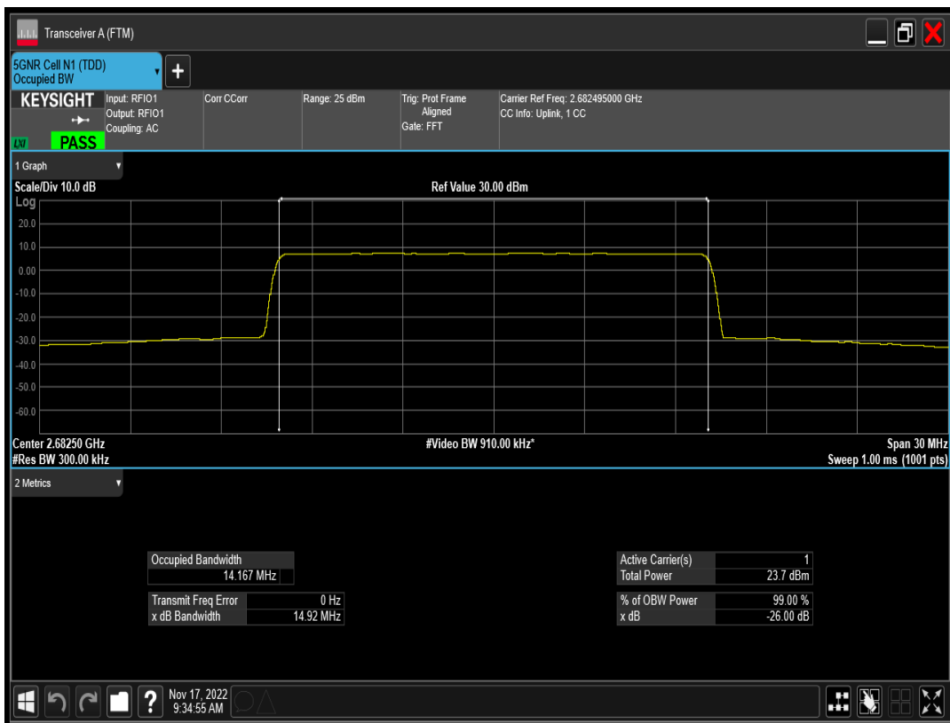
n41 SCS=15kHz CP_QPSK BW=15MHz Channel=536499 RB=79@0
