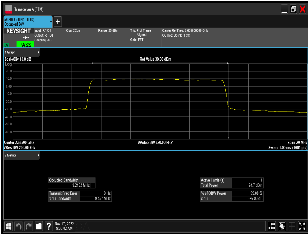
n41 SCS=15kHz DFT_QAM64 BW=10MHz Channel=537000 RB=50@0
