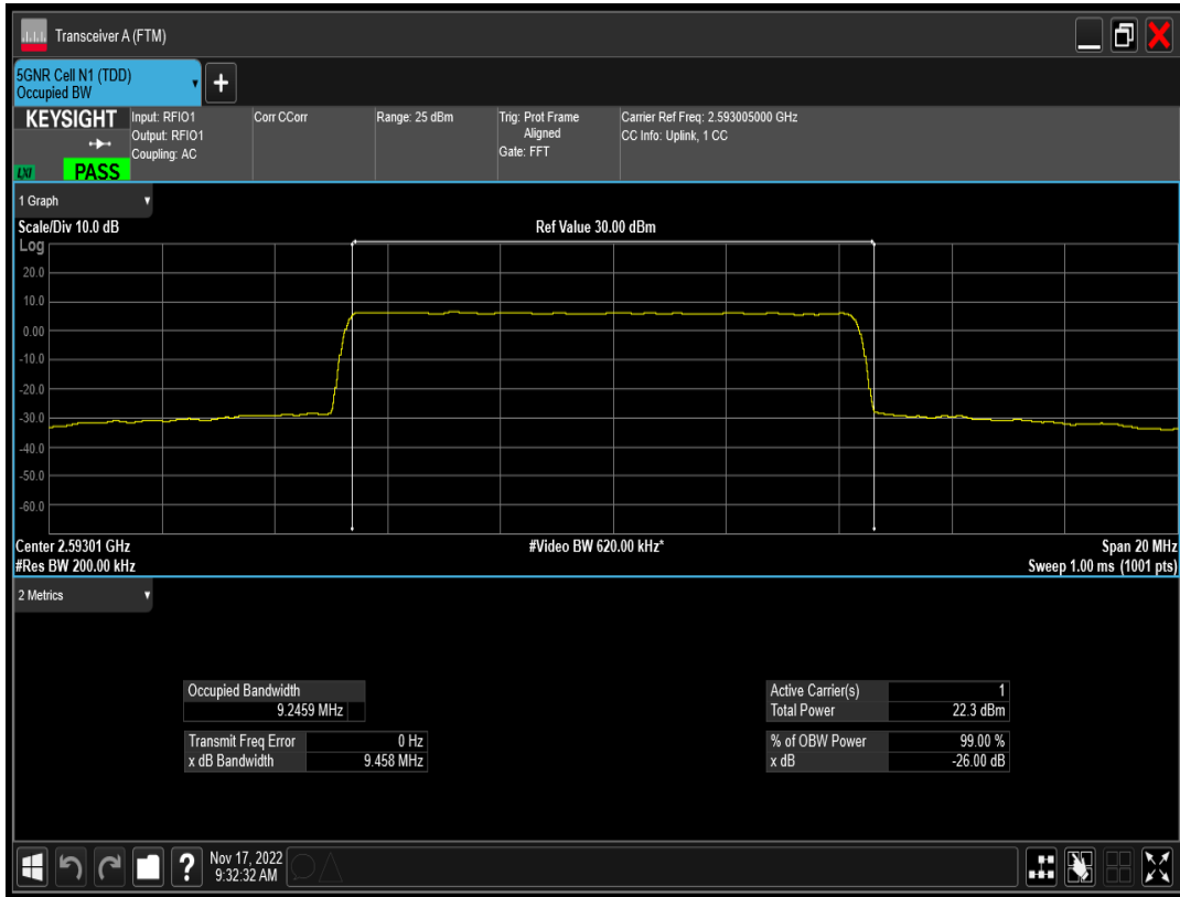
n41 SCS=15kHz CP_QPSK BW=10MHz Channel=518601 RB=52@0
