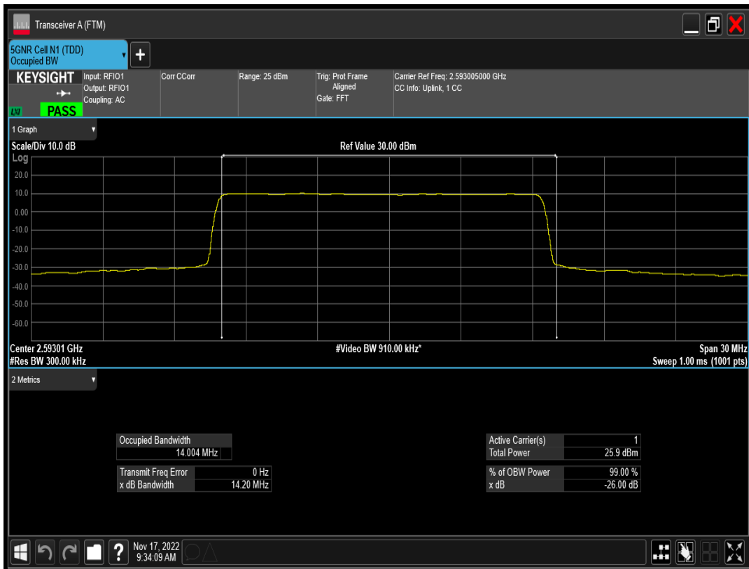
n41 SCS=15kHz DFT_QPSK BW=15MHz Channel=518601 RB=75@0
