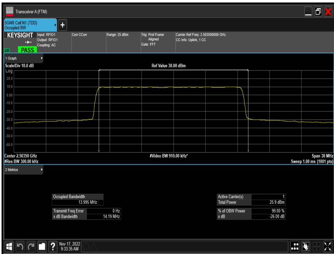
n41 SCS=15kHz DFT_QPSK BW=15MHz Channel=500700 RB=75@0
