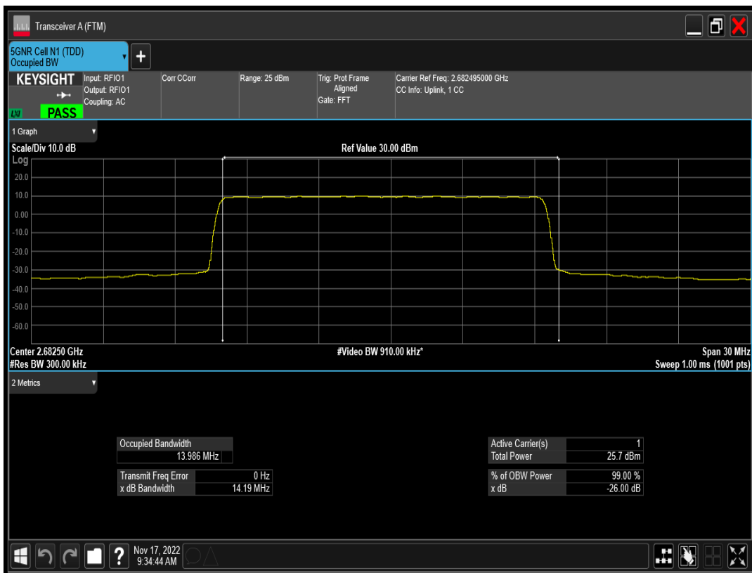
n41 SCS=15kHz DFT_QPSK BW=15MHz Channel=536499 RB=75@0
