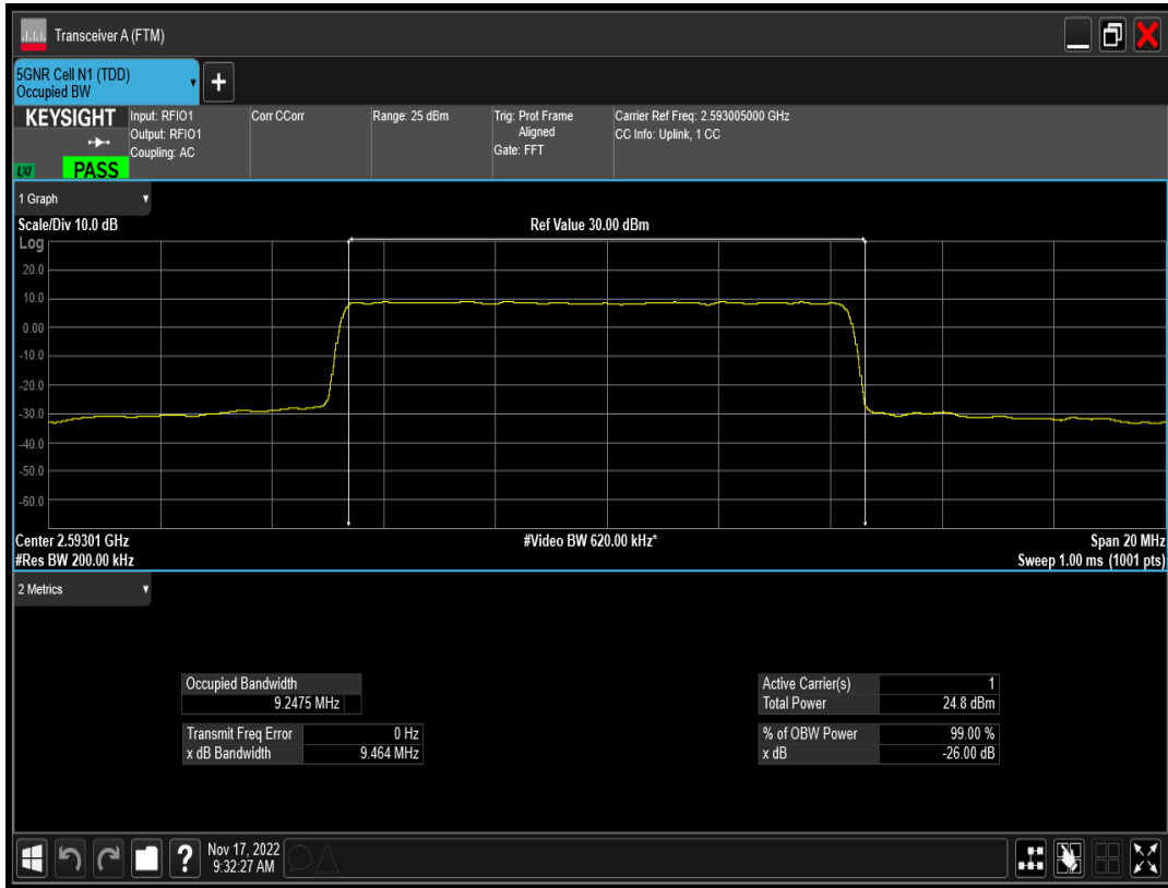
n41 SCS=15kHz DFT_QAM64 BW=10MHz Channel=518601 RB=50@0
