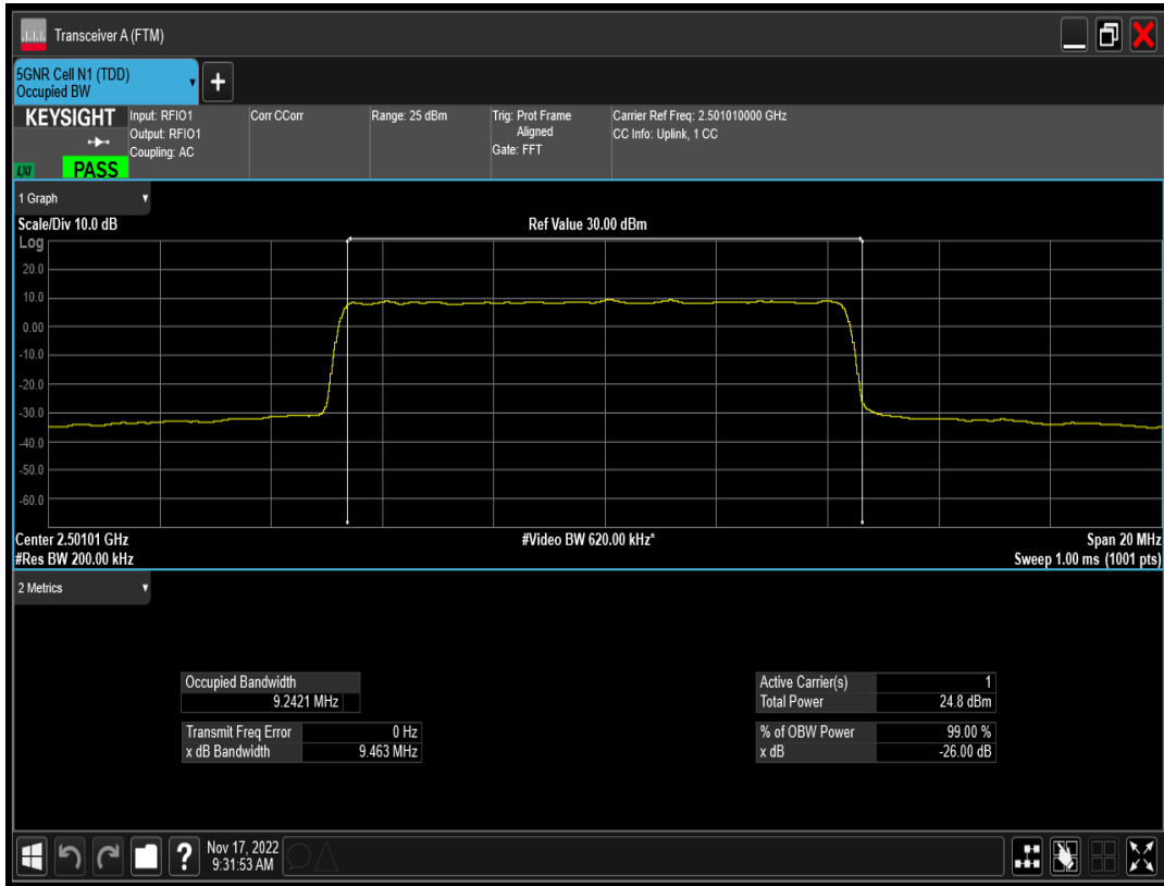
n41 SCS=15kHz DFT_QAM64 BW=10MHz Channel=500202 RB=50@0
