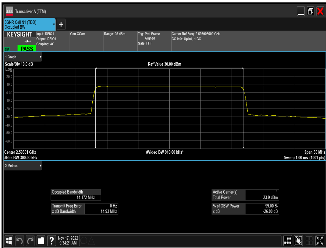
n41 SCS=15kHz CP_QPSK BW=15MHz Channel=518601 RB=79@0
