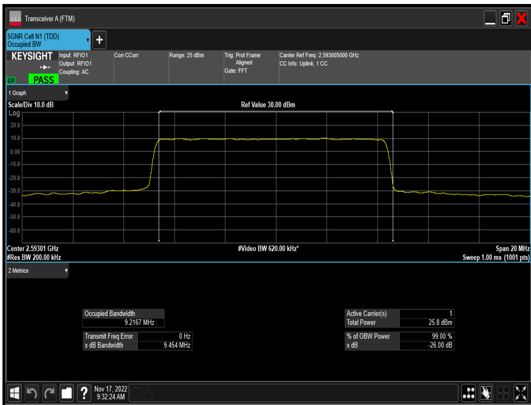
n41 SCS=15kHz DFT_QPSK BW=10MHz Channel=518601 RB=50@0
