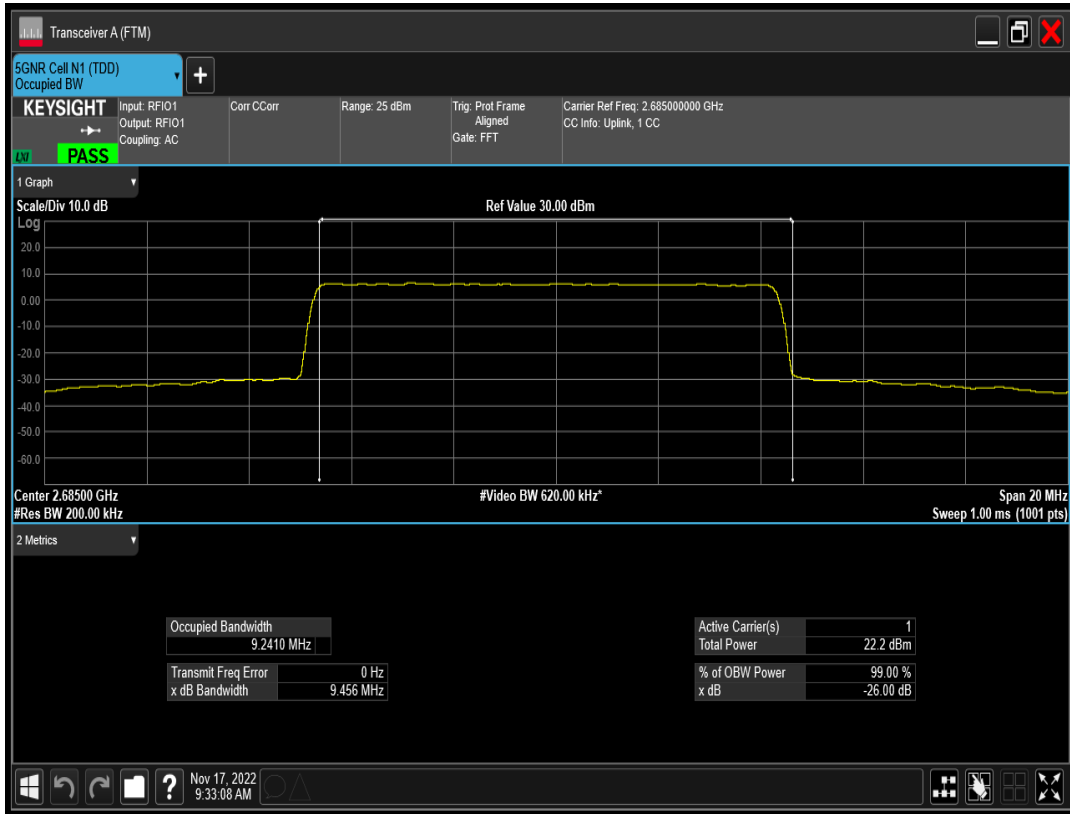
n41 SCS=15kHz CP_QPSK BW=10MHz Channel=537000 RB=52@0
