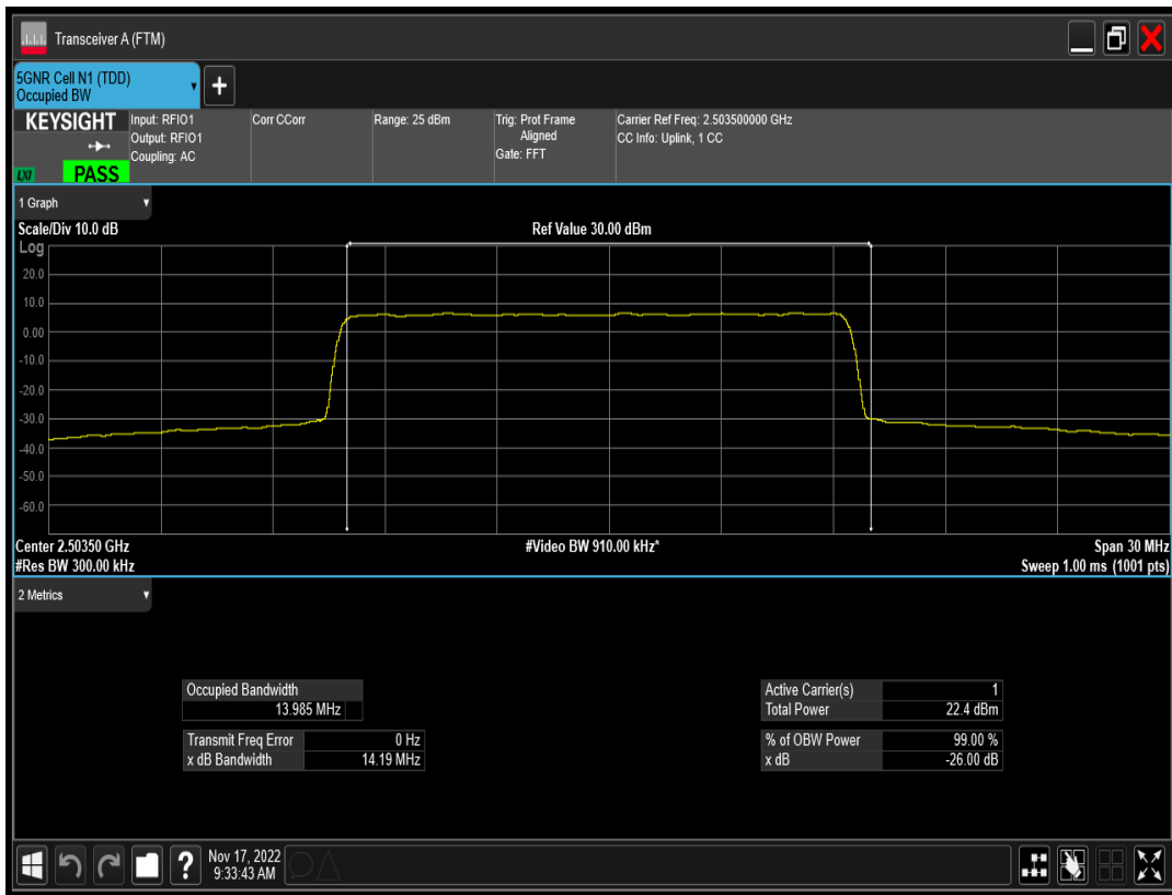
n41 SCS=15kHz CP_QPSK BW=15MHz Channel=500700 RB=79@0
