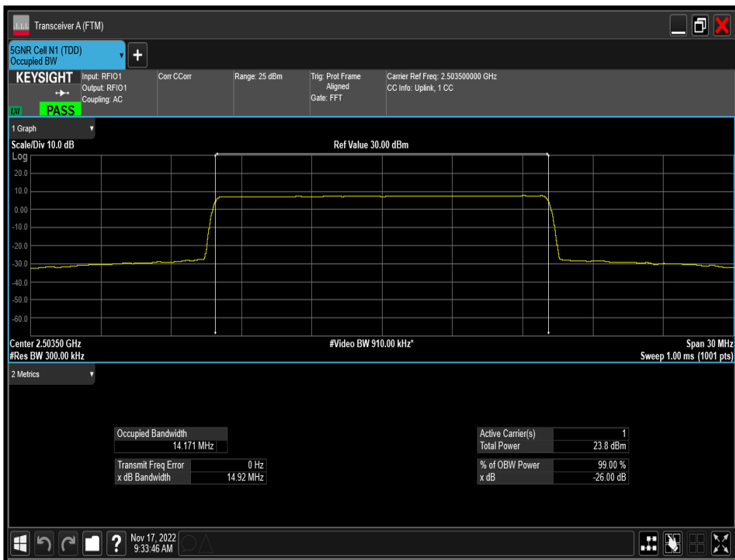
n41 SCS=15kHz CP_QPSK BW=15MHz Channel=500700 RB=79@0
