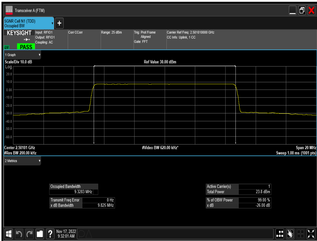
n41 SCS=15kHz CP_QPSK BW=10MHz Channel=500202 RB=52@0
