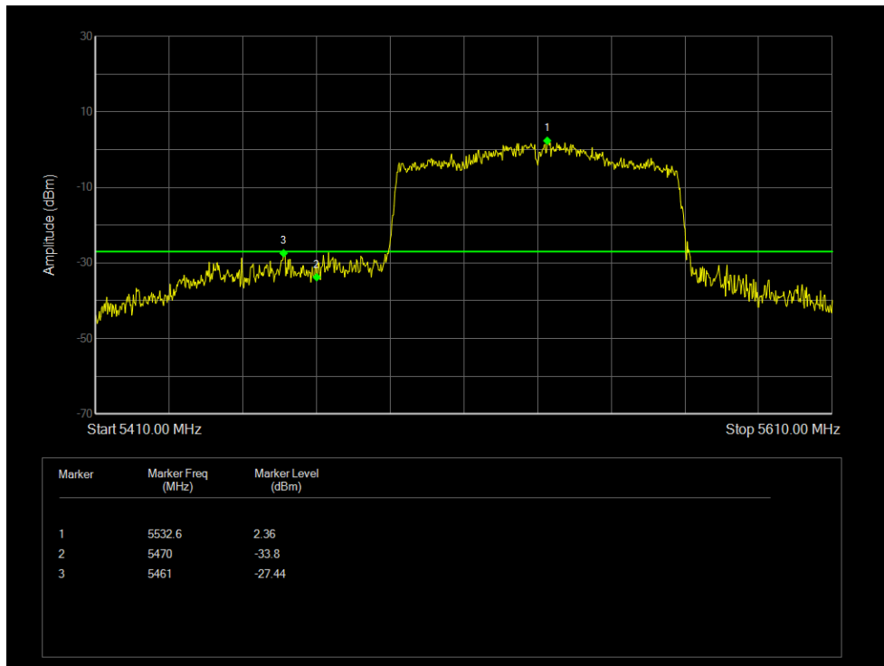
Band Edge NVNT 802.11ac80 5610MHz High Ant1
