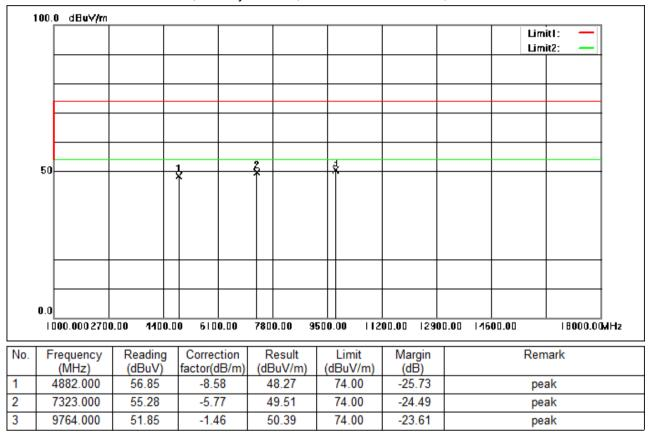
Test Mode: 00; Polarity: Vertical; Modulation:π/4 DQPSK; Channel:middle
