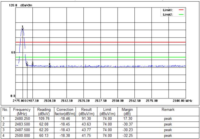
Test Mode: 00; Polarity: Vertical; Modulation:π/4 DQPSK; Channel:High
