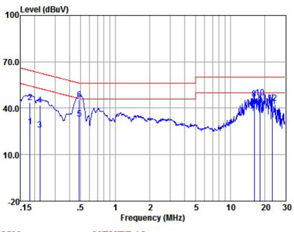
LISN : NEUTRAL EUT/Project No : 7466CR Test mode : a
