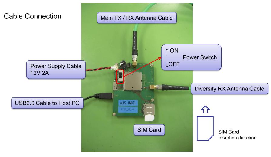
Turn ON the Power Switch. Then the UMDZ1 module will start booting automatically. After about ten seconds, the UMDZ1 module will be ready to connect to the cellular network. 電源スイッチをONにするとモジュールは自動的に起動を開始します。 およそ10秒後にセルラーネットワークへの接続待機状態となります。
