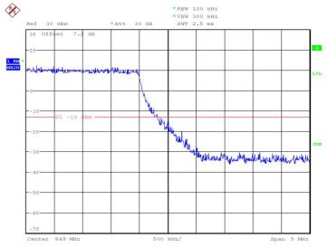
HIGH BAND EDGE BLOCK-QPSK-10MHz-100%RB
