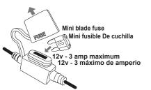
To replace fuse, remove fuse and replace with like amperage. Para cambiar el fusible, sague el fusible y reemplácelo con uno de amperaje similar
