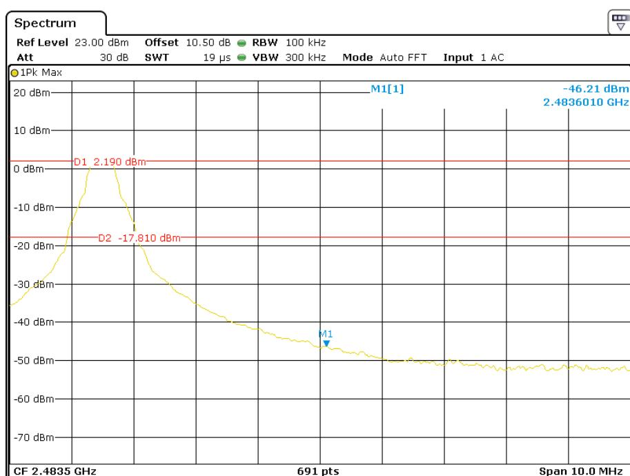
**EDR ( $\pi/4$ -DQPSK): Band Edge-Left Side**
