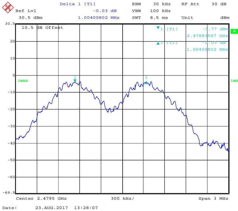
**EDR ( $\pi/4$ -DQPSK): Low Channel**
