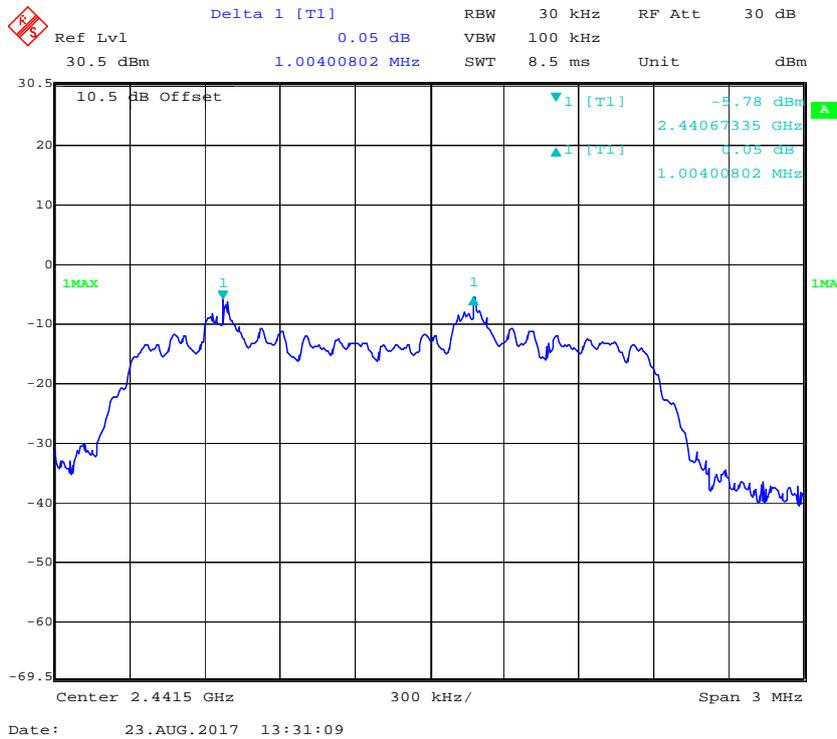
**EDR ( $\pi/4$ -DQPSK): High Channel**
