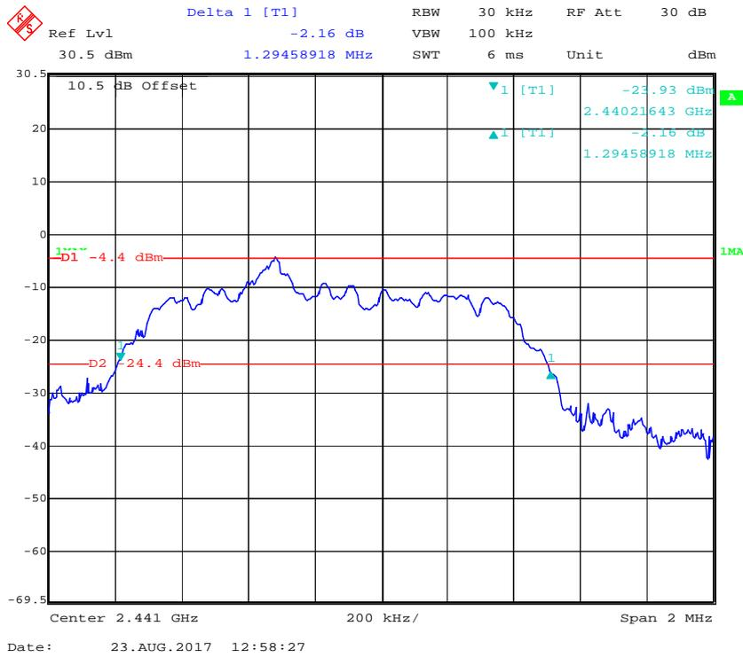
**EDR ( $\pi/4$ -DQPSK): High Channel**
