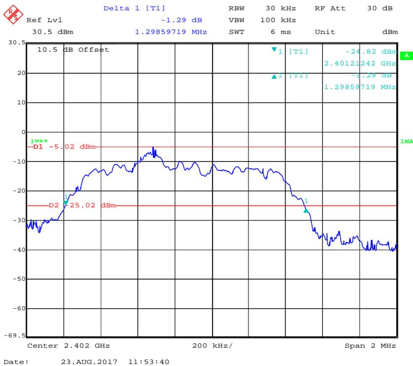
**EDR ( $\pi/4$ -DQPSK): Middle Channel**
