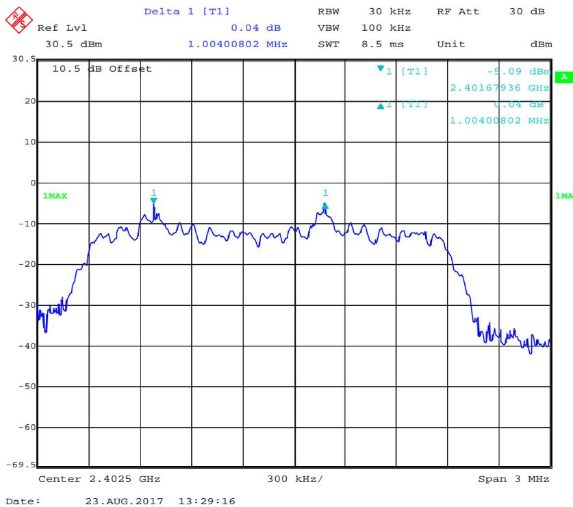
**EDR ( $\pi/4$ -DQPSK): Middle Channel**
