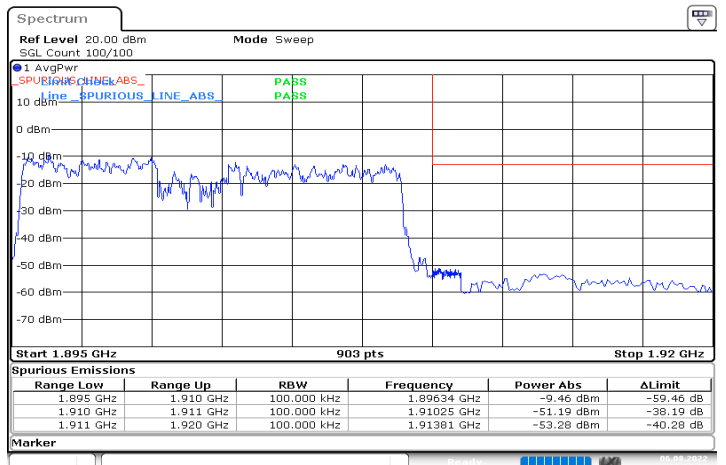
DC_12A_n2A_10MHz|15MHz_15kHz_707.5MHz|1902.5MHz_ DFT-s-OFDM QPSK_RB0|RB75@0
