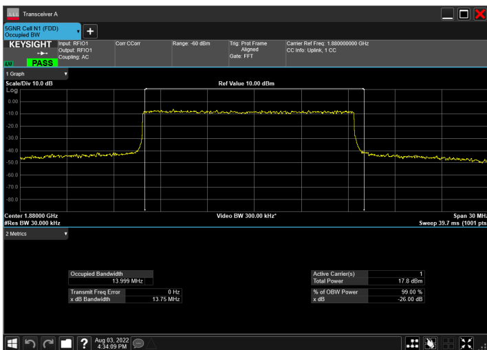
DC_12A_n2A_10MHz|15MHz_15kHz_707.5MHz|1880MHz_Q PSK|DFT-s-OFDM 256 QAM_RB1@50|RB75@0
