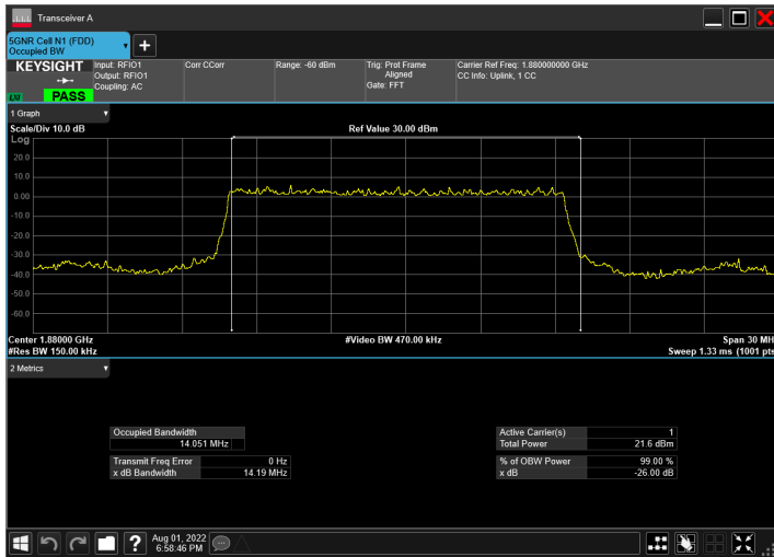
n2_15MHz_15kHz_1880MHz_DFT-s-OFDM PI/2 BPSK_RB75@0
