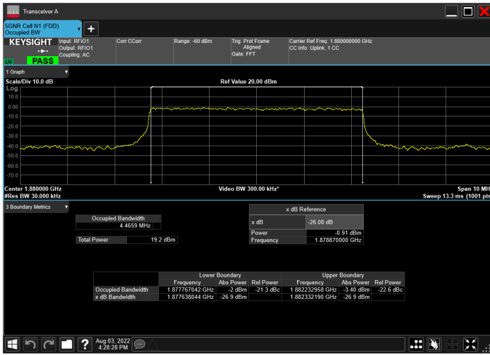
DC_12A_n2A_10MHz|5MHz_15kHz_707.5MHz|1880MHz_QP SK|DFT-s-OFDM PI/2 BPSK_RB1@50|RB25@0
