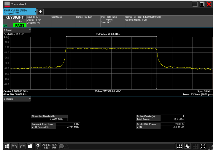
DC_12A_n2A_10MHz|5MHz_15kHz_707.5MHz|1880MHz_QP SK|CP-OFDM 64 QAM_RB1@50|RB25@0
