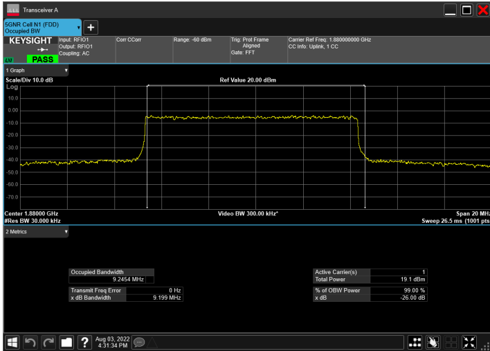
DC_12A_n2A_10MHz|10MHz_15kHz_707.5MHz|1880MHz_Q PSK|DFT-s-OFDM 64 QAM_RB1@50|RB50@0
