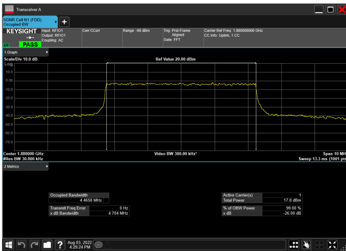
DC_12A_n2A_10MHz|5MHz_15kHz_707.5MHz|1880MHz_QP SK|DFT-s-OFDM 256 QAM_RB1@50|RB25@0
