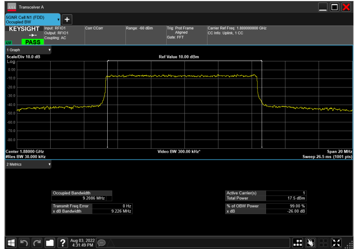
DC_12A_n2A_10MHz|10MHz_15kHz_707.5MHz|1880MHz_Q PSK|DFT-s-OFDM 256 QAM_RB1@50|RB50@0
