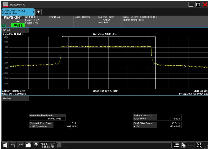
DC_12A_n2A_10MHz|15MHz_15kHz_707.5MHz|1880MHz_Q PSK|CP-OFDM 256 QAM_RB1@50|RB79@0
