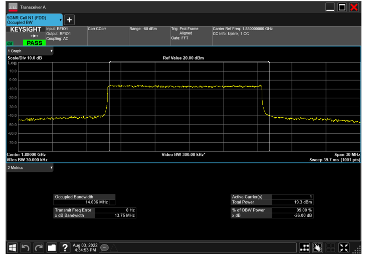
DC_12A_n2A_10MHz|15MHz_15kHz_707.5MHz|1880MHz_Q PSK|CP-OFDM 64 QAM_RB1@50|RB79@0
