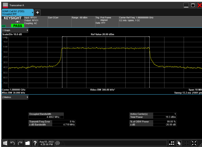
DC_12A_n2A_10MHz|5MHz_15kHz_707.5MHz|1880MHz_QP SK|DFT-s-OFDM 16 QAM_RB1@50|RB25@0
