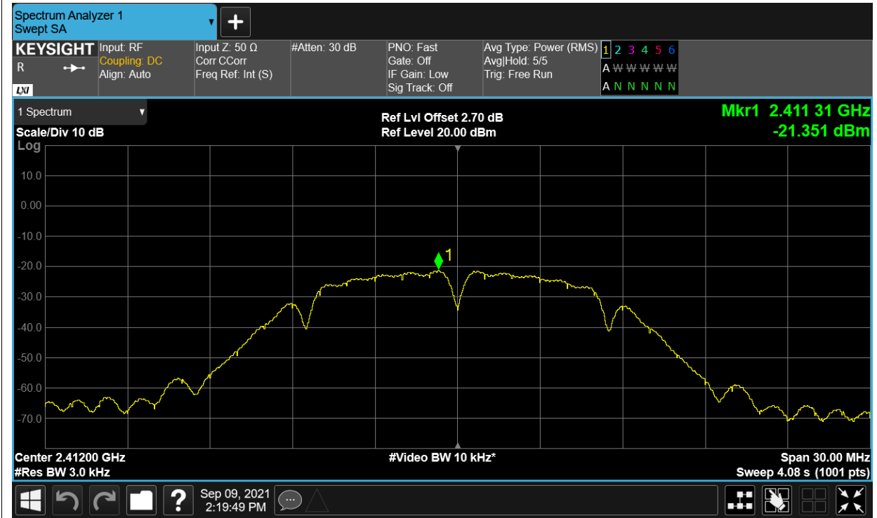
PSD NVNT b 2437MHz Ant1
