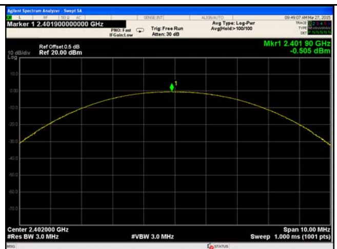
\pi/4 DQPSK Output power - Low CH 2402
