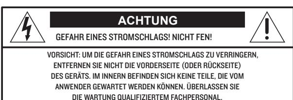
**ACHTUNG** Der Blitz mit Pfeilspitze im gleichseitigen Dreieck soll den Anwender vor Nichtisolierter "gefährlicher Spannung" im Gerätinneren warnen. Diese kann so hoch sein, dass die Gefahr eines Stromschlags besteht.
