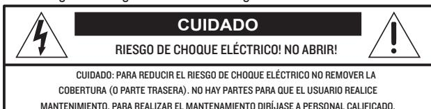
El símbolo de relámpago con punta de flecha dentro de un triángulo equilátero tiene como fin alertar al usuario de la presencia de "voltaje peligroso" no aislado dentro del producto, lo cual puede ser de magnitud suficiente como para constituir un riesgo de choque eléctrico a una persona.
