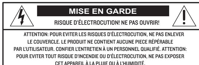
Le symbole de l'éclair à l'intérieur d'un triangle équilatéral est utilisé pour alerter l'utilisateur de la présence "tensions dangereuses" non isolées à l'intérieur du produit, et de potentiel suffisant pour constituer un risque sérieux d'électrocution.
