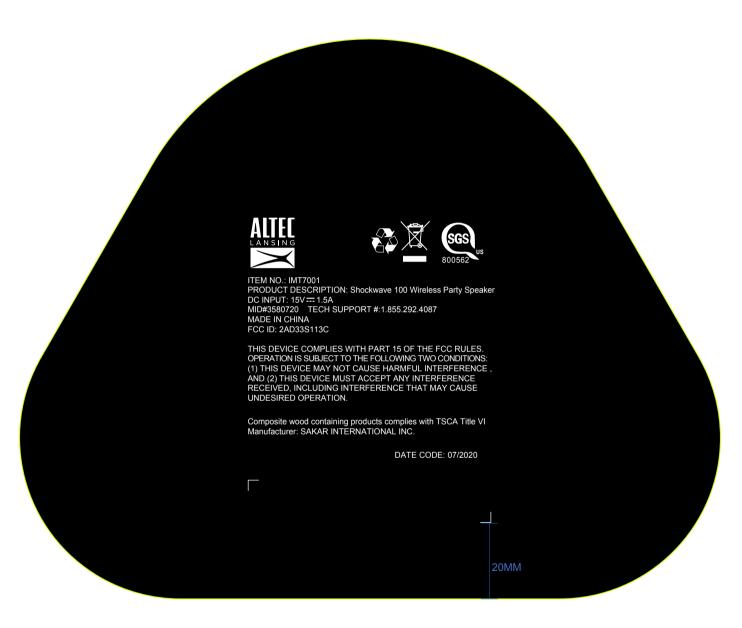
S113左PC片,L185.4\*W148\*T0.25MM,材质PC,磨砂面黑色底,背面背3M胶丝印后板贴纸信息(SAKAR客户专用)结构同30612F00S113-004 料号: 30612F00S113-003
