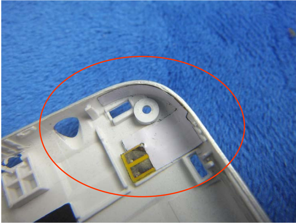
BT/WIFI/GPS - Antenna View
