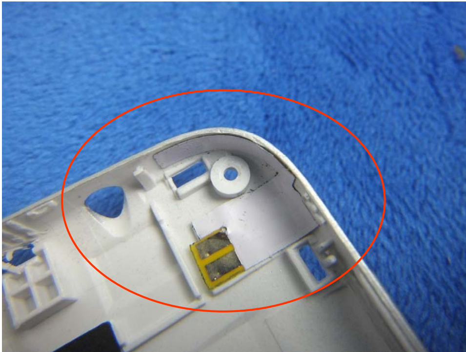
BT/WIFI/GPS - Antenna View
