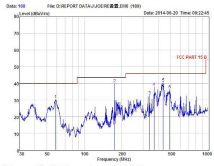
: FCC PART 15 B 3m : Condeco 10.1'' Touch Screen : PN41827 POL: VERTICAL Condition
