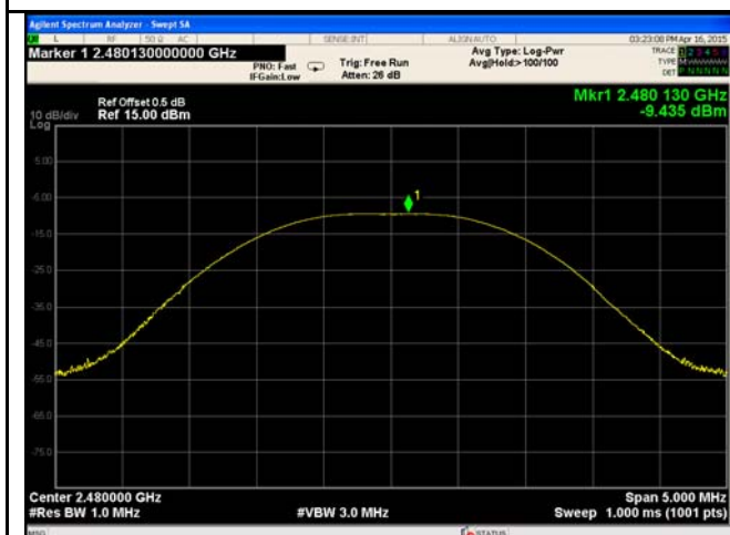
AV Output power - High CH 2480
