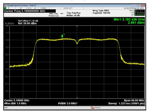
PSD 802.11ac(VHT40) 5230MHz
