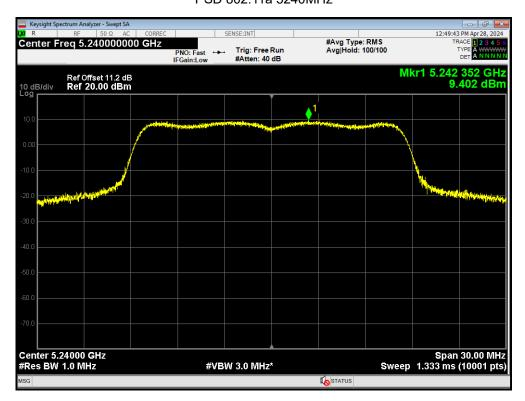
PSD 802.11ac(VHT20) 5180MHz
