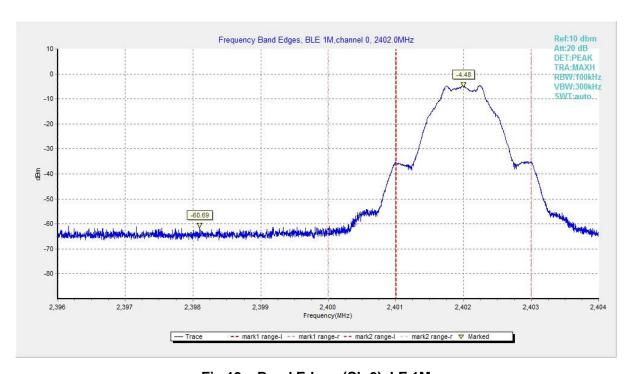
Fig.13 Band Edges (Ch 0), LE 1M
