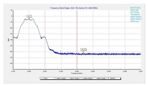
Fig.14 Band Edges (Ch 39), LE 1M
