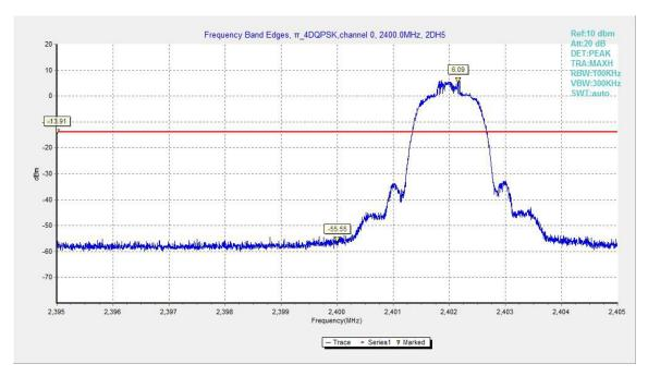
Fig.5. Frequency Band Edges: π/4 DQPSK, Channel 0, Hopping Off
