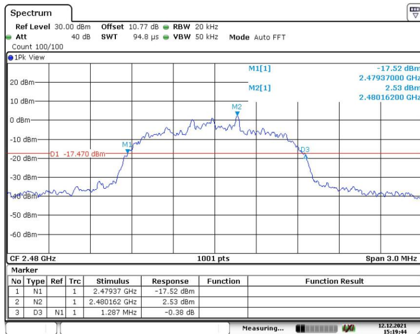
Fig. 72 20dB Bandwidth ( \pi/4 DQPSK, CH78)
