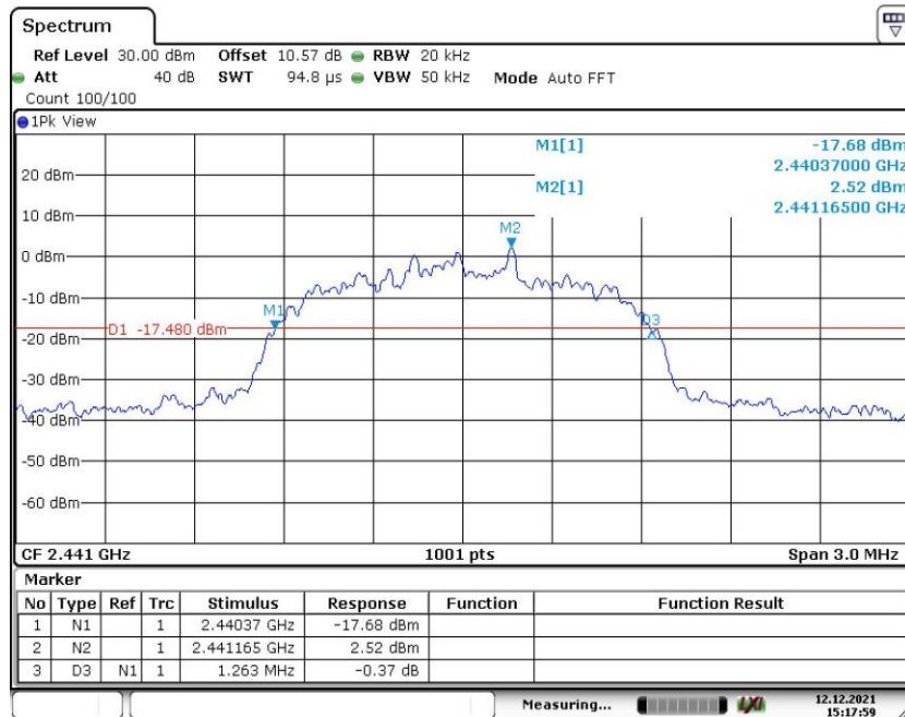
Fig. 71 20dB Bandwidth ( \pi/4 DQPSK, CH39)
