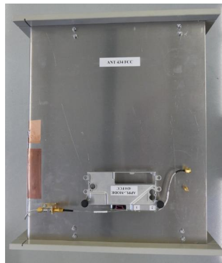
Back Side of Replacement Antenna mit mounted RKE223E1 Module
